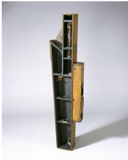
Figura 5 – Espectrómetro de Dobson, datado de 1926 (Science Museum, 2014)
