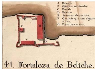
Técnica de Construção: Alvenaria, pedra, madeira, telha portuguesa, os blocos de pedra, não aparelhados, envolvidos por argamassa do tipo arenoso, para enchimento das cortinas do forte e dos baluartes, existindo também blocos aparelhados para apoio da barbete, alvenaria de pedra e silharia, na sua maioria com cerca 30 a 40 cm de comprimento e 20 a 30 cm de largura
