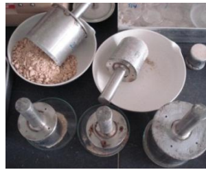
Figura 2.5 - Determinação dos pesos volúmicos pelo método do extrator (ensaio “in situ”).
