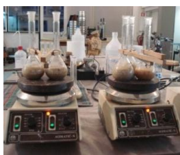
Figura 2.14 – Picnómetros em placas de aquecimento para a determinação de densidades.
