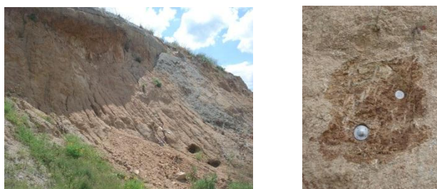
Figura 2.2 - Perfil de solo residual de quartzodiorito na pedreira de Benafessim em Montemor-o-Novo (à esquerda) e respetiva recolha de amostras (à direita).
