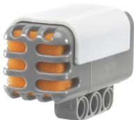
Figura 3.7: Sensor ultra-sónico e sensor de som
