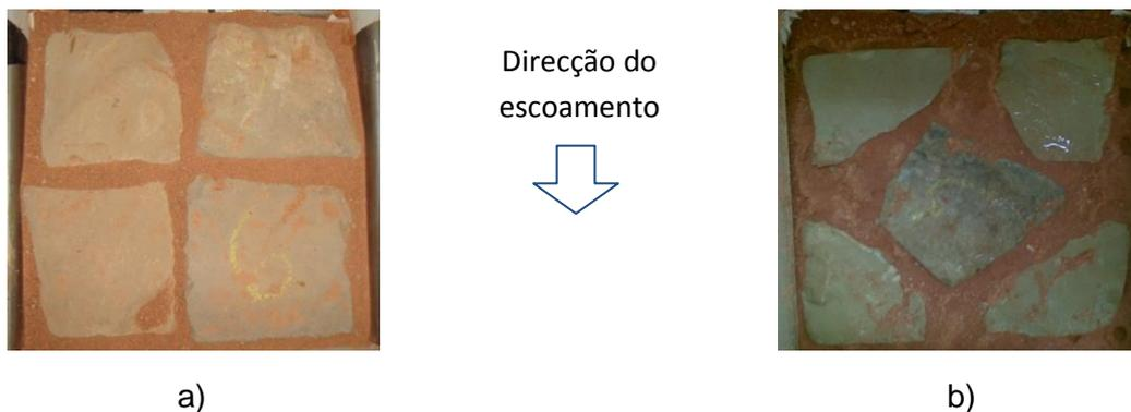
Figura 4.14 – Pavimento em calçada grossa com: a) juntas na direcção do escoamento e b) juntas a 45° com o escoamento.
