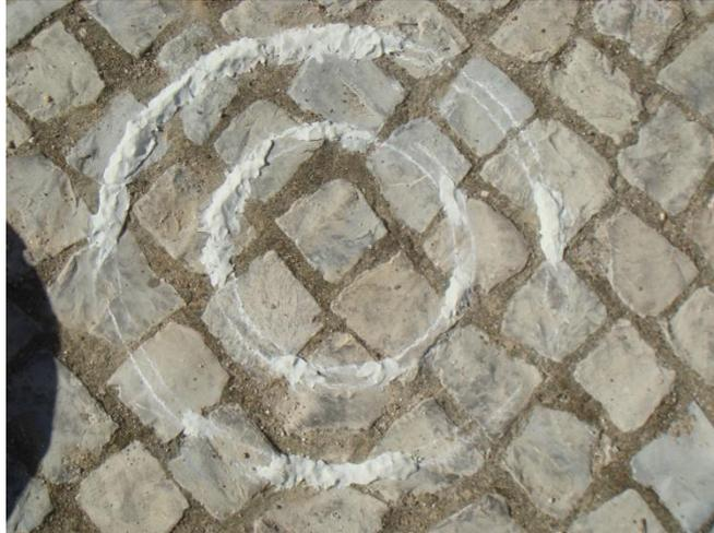
Figura 4.16 – Camada base para o infiltómetro constituída por massa de moldar sobre a calçada grossa.
