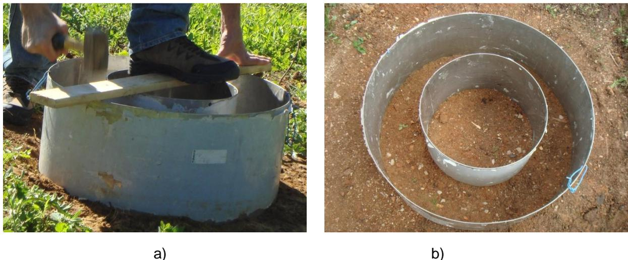
Figura 4.15 – Ensaio de infiltração no solo: a) colocação do infiltrómetro e b) infiltrómetro cravado no solo.
