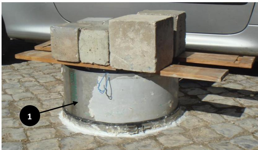
Figura 4.17 – Disposição do equipamento em ensaio com carga hidráulica variável.
