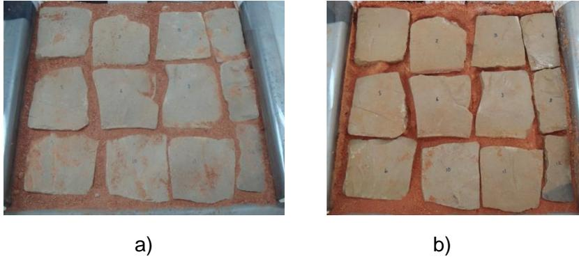
Figura 5.2 – Calçada miúda com juntas paralelas à direcção do escoamento: a) antes da série de ensaios e b) após a série de ensaios.
