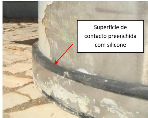
Figura 4.6 – Pormenor da adaptação do infiltrómetro aos ensaios no pavimento.
