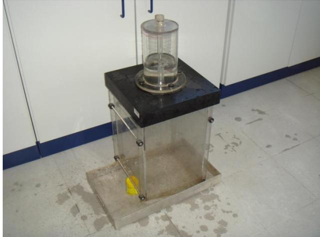
Figura 4.23 – Determinação da intensidade de precipitação.
