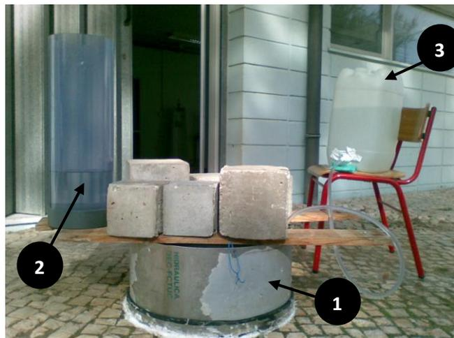
Figura 4.20 – Disposição do equipamento em ensaio com carga hidráulica constante.
