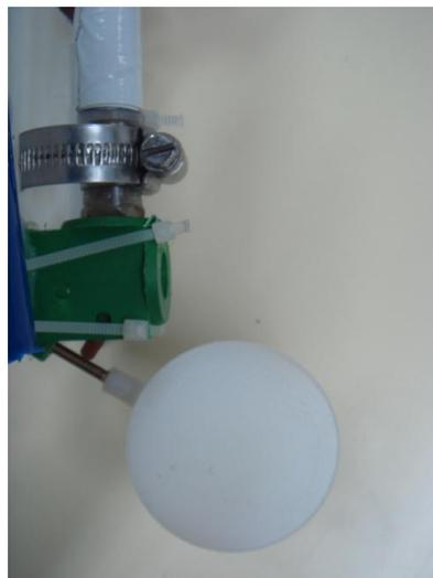
Figura 4.9 – Válvula controlada por bóia para obtenção de carga constante.
