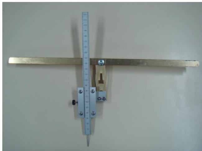
Figura 4.7 – Limnímetro de ponta com régua micrométrica.
