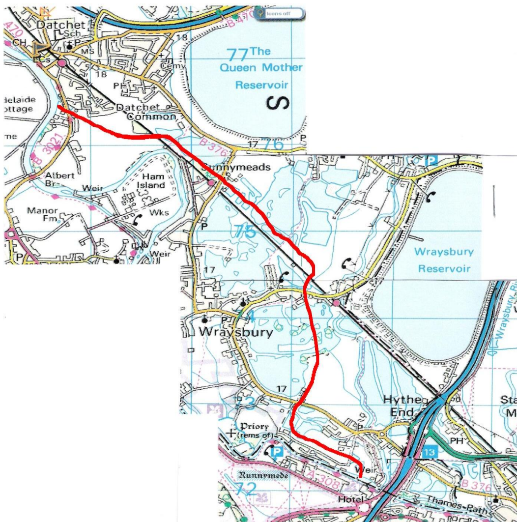
Figura 2.29 – Esquema de um canal de derivação de caudais de cheia (linha vermelha), através das vilas Datchet, Horton e Wraysbury , localizadas na zona baixa do Rio Tamisa, em Inglaterra (Jubilee River, 2010).
