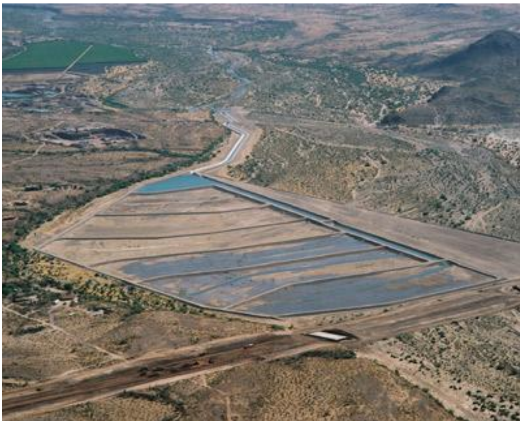
Figura 2.4 – Exemplo de uma bacia para recarga de aquíferos. Observa-se a zona onde se promove a recarga das águas subterrâneas recorrendo ao espalhamento dos caudais provenientes de cheias repentinas (CAP, 2011).
