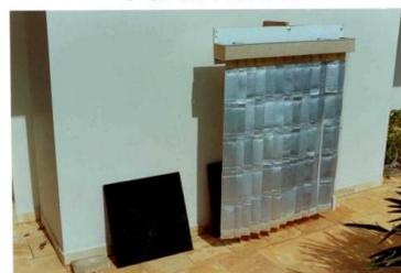
TESTE: COLOCADA DO LADO DE FORA. TEMPERATURAS MEDIDAS NAS PLACAS DE MADEIRA PINTADAS DE PRETO
