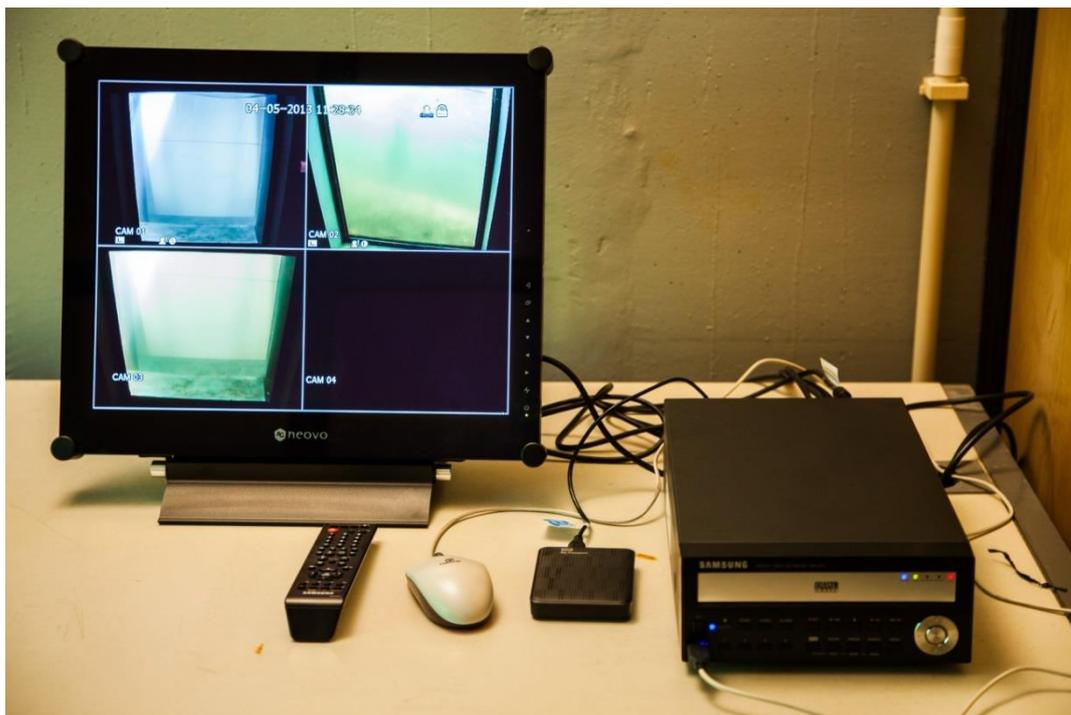
Figura 10 - Monitor, gravador e dispositivo de backup (disco externo).
