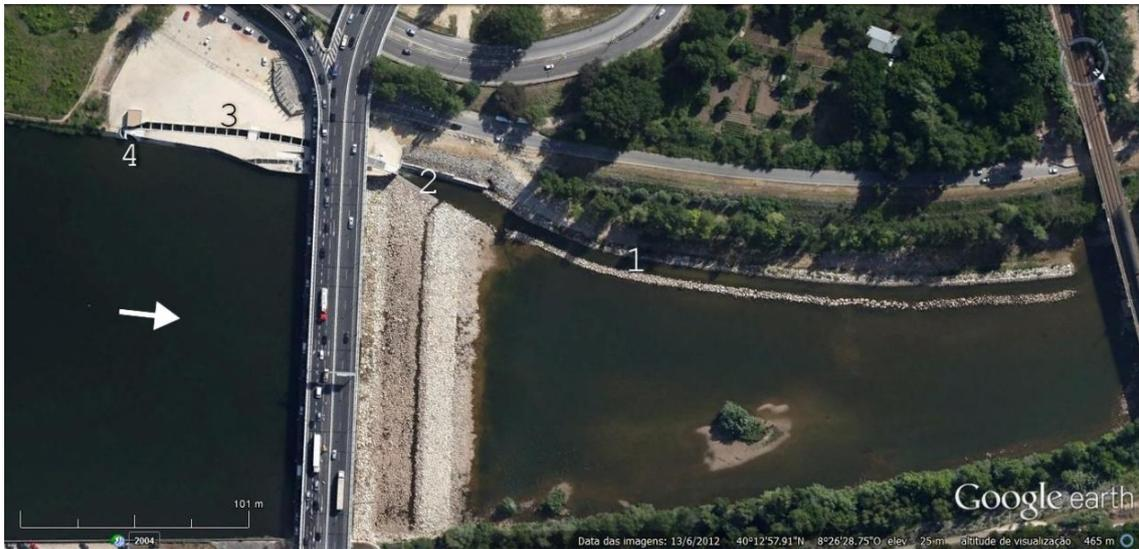
Figura 5 – Imagem de satélite do Açude-Ponte de Coimbra onde é visível a jusante o canal de atração (1), a entrada da PPP (2), as bacias sucessivas (3) e a saída da PPP junto à infra-estrutura que apoia a monitorização hidráulica e biológica (4). Sentido do fluxo →.
