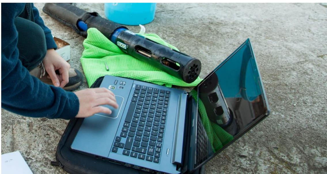
Figura 12 - Sonda multiparamétrica e respetivo procedimento de backup.
