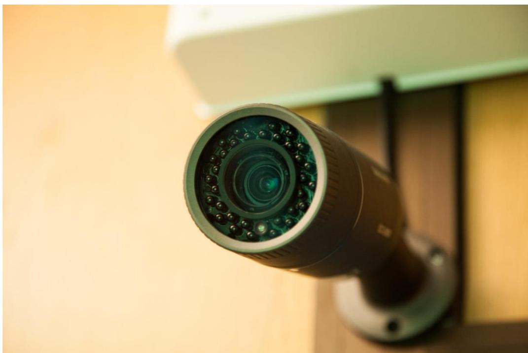
Figura 11 - Camara de captação de imagens com sistema LED incorporado.
