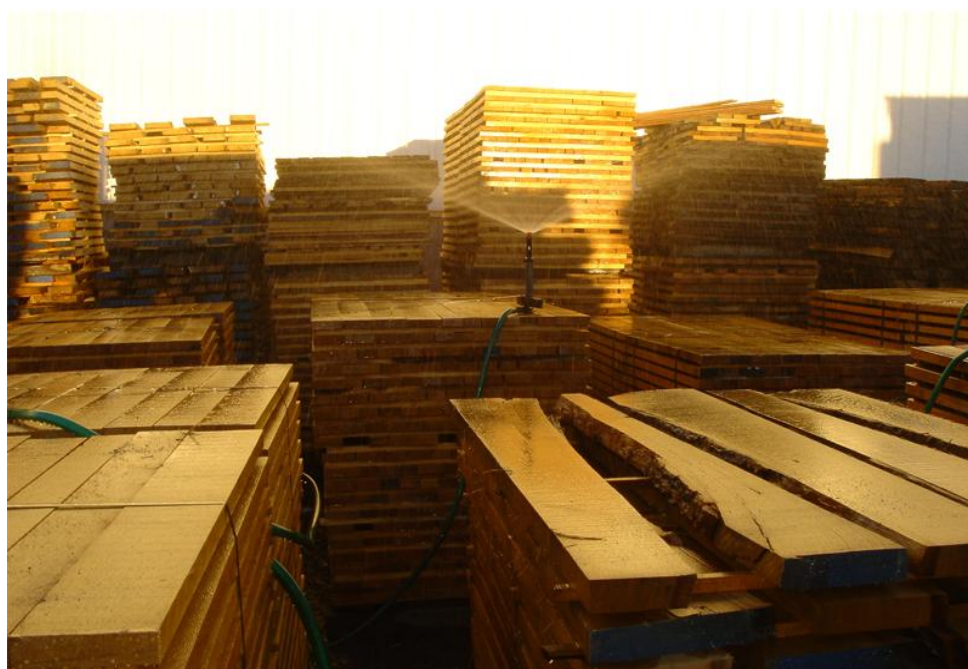
Fig. 3 - Secagem natural sob condições controladas. Fonte: Tacopal, 2007.
