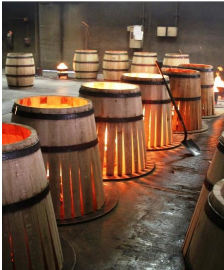
Fig. 4 - Processo de tosta como forma de moldar fisicamente a madeira. Fonte: MauOscar, 2010.
