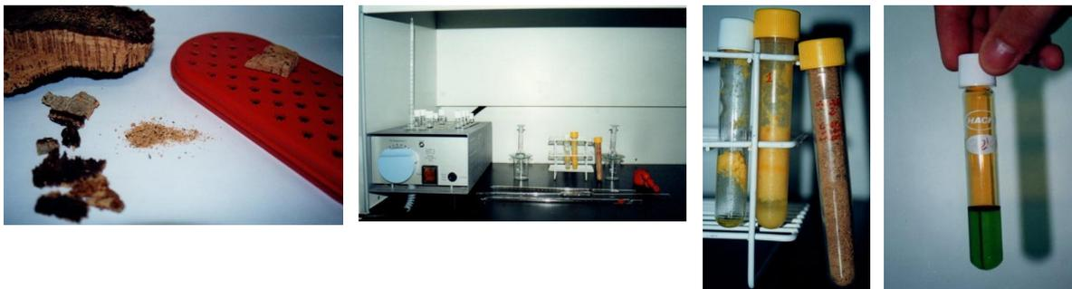
Figuras 10, 11, 12 e 13 – A cortiça em prancha, as faces externas subtraídas, os grânulos, o felema e o granulador. O digestor térmico. Duas fases da digestão do felema de cortiça e uma porção de grânulos. O resultado final da digestão.
