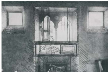
44. Esquisso de Carlo Scarpa sobre uma fotografia, estudando a solução para as entradas de luz da segunda sala da Galleria delle Sculture .
