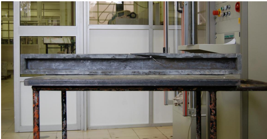
Figura 4.29: Aspecto da Viga 2 após rotura – vista lateral.
