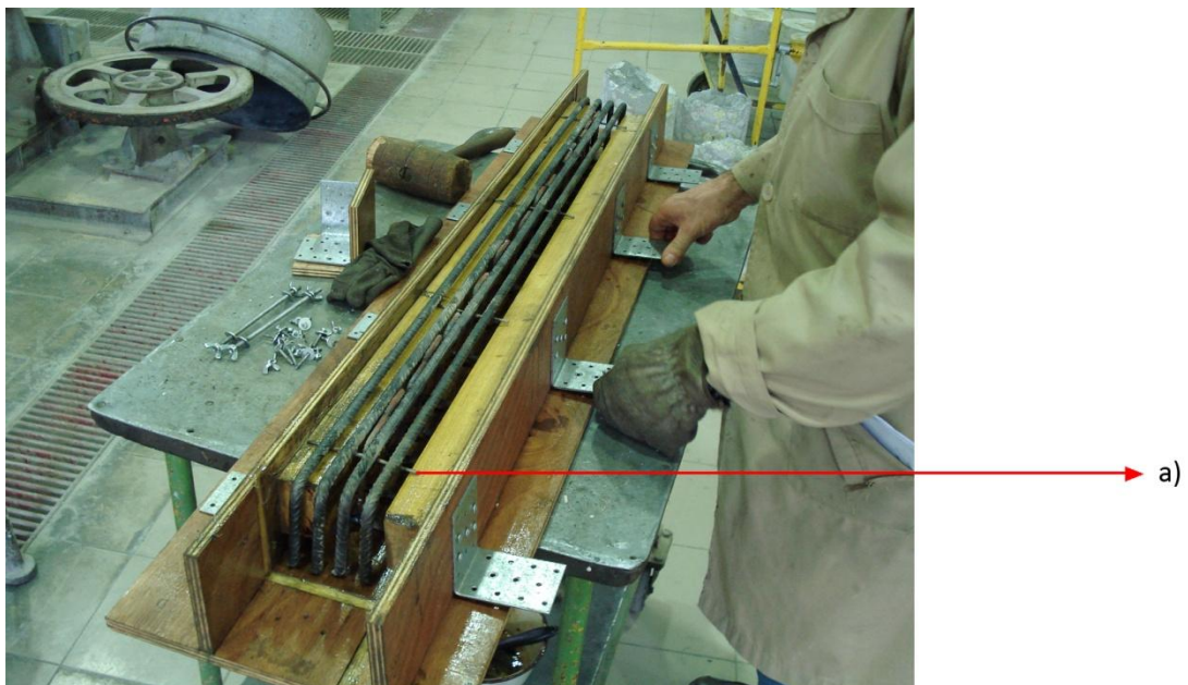
Figura 4.4: a) Varão de 4mm na fixação da armadura/molde
