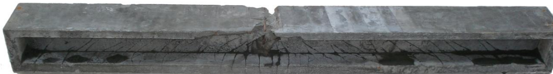
Figura 4.65: Aspecto da Viga 7 após rotura (Vista oposta à da figura 4.64)
