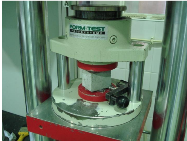
Figura 4.14: Ensaio dos meio prismas à compressão
