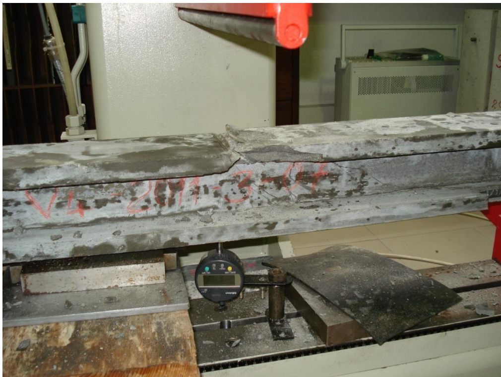
Figura 4.44: Rotura da Viga 4
