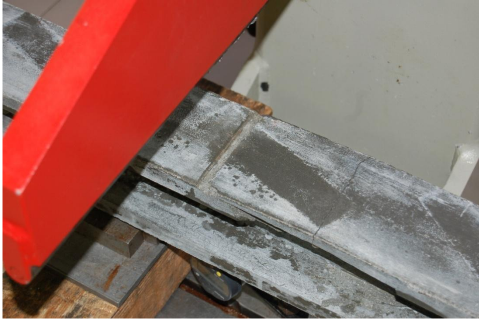
Figura 4.28: Aspecto da Viga 2 após rotura.
