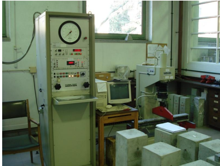
Figura 4.20: Máquina de ensaios de vigas à flexão
