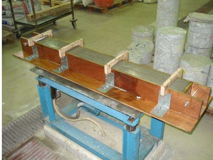
Figura 4.17: Final do processo de betonagem
