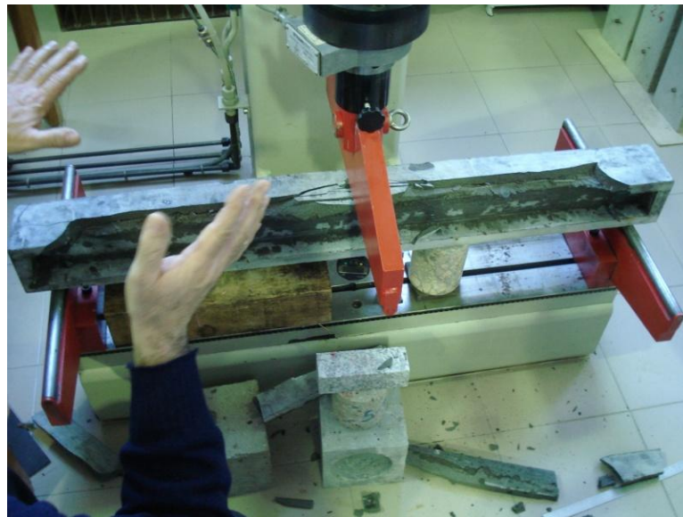
Figura 4.22: Aspecto da Viga 1 após rotura
