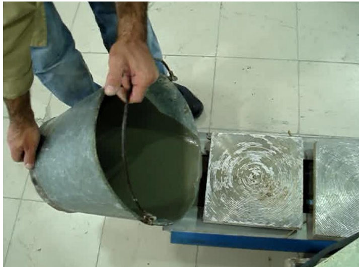
Figura 4.74: Betonagem do prisma
