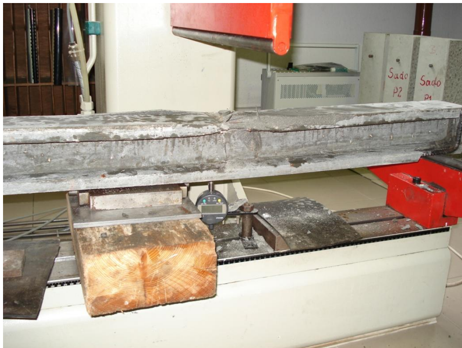
Figura 4.38: Aspecto da Viga 3 após rotura.
