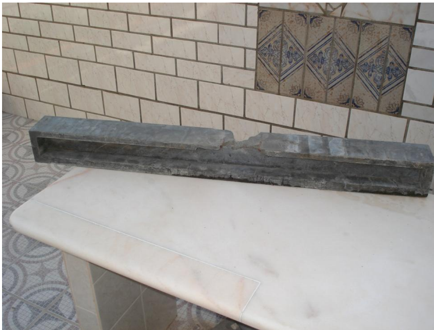
Figura 4.53: Aspecto da Viga 5 após a rotura.
