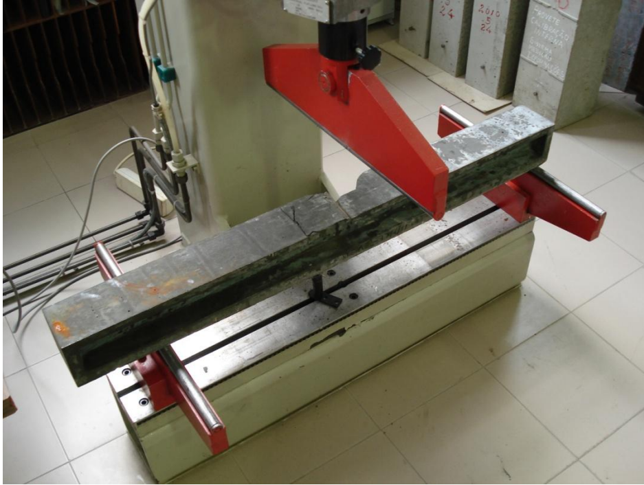
Figura 4.56: Aspecto da Viga 6 após a rotura.
