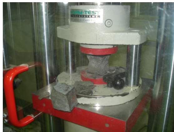
Figura 4.15: Rotura à compressão do meio prisma
