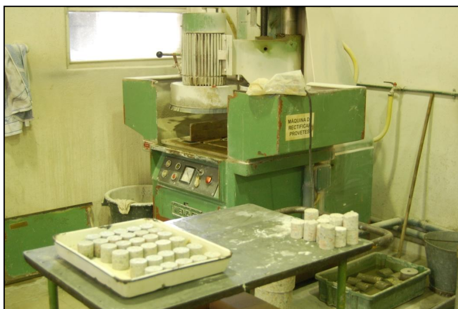
Figura 30 – Rectificação dos provetes.
