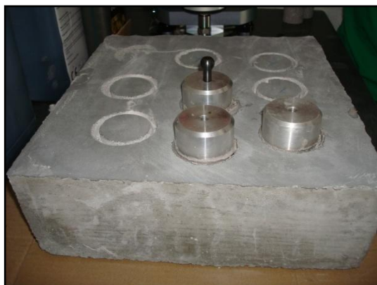
Figura 33 – Colagem das bolachas na lajeta.
