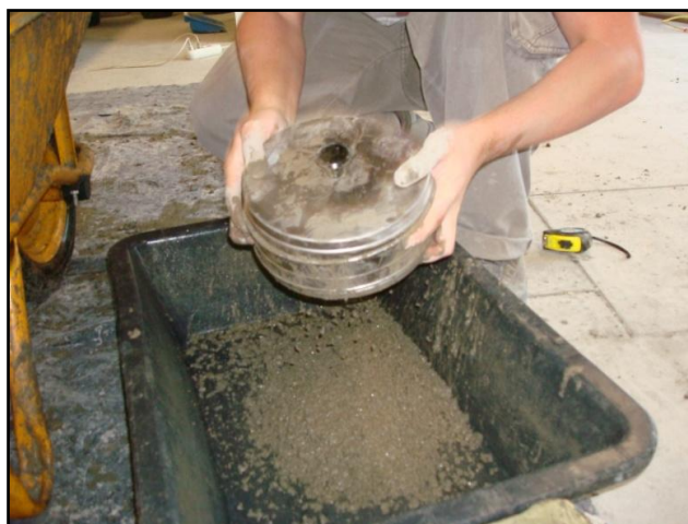
Figura 23 – Peneiração do betão de base.
