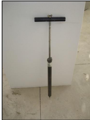
Figura 24 – Equipamento de medição do índice de presa.
