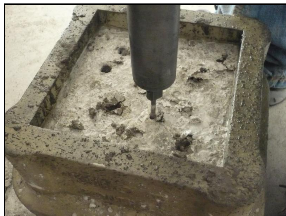
Figura 25 – Medição do índice de presa.
