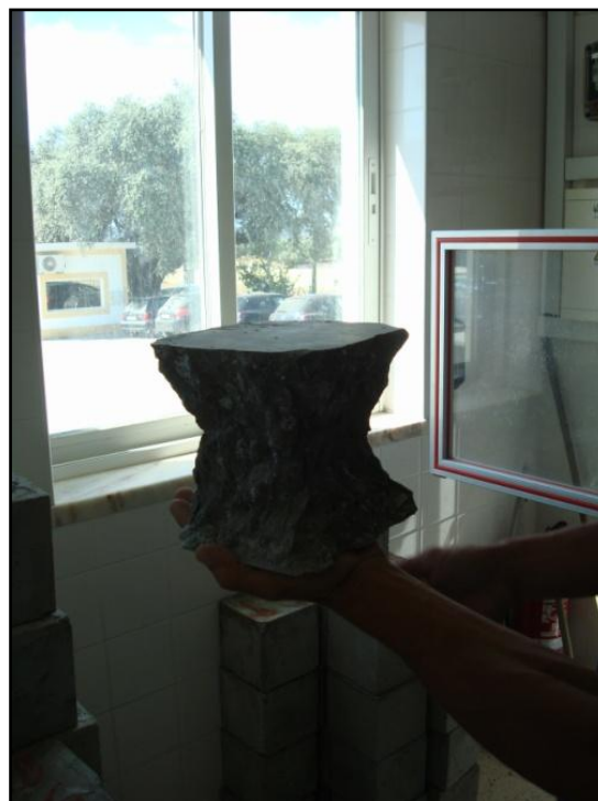
Figura 27 – Rotura satisfatória de um provete cúbico.
