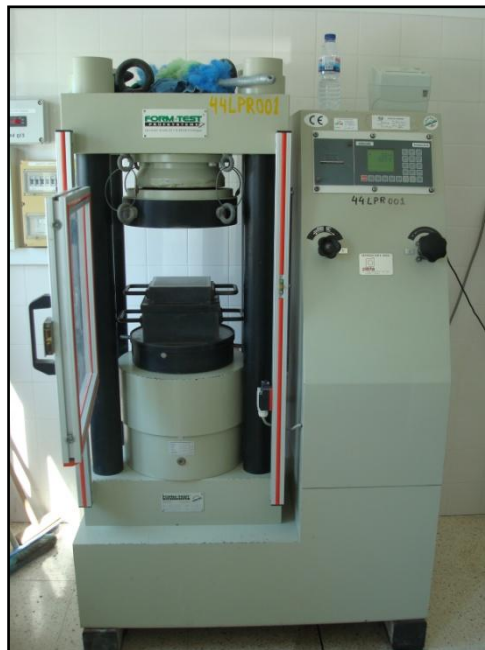
Figura 26 – Máquina de ensaio à compressão dos provetes cúbicos.
