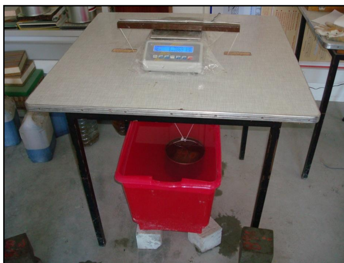
Figura 35 – Pesagem do provete imerso.
