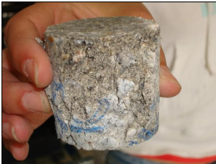
Figura 32 – Provede cilíndrico depois de ensaiado à compressão.
