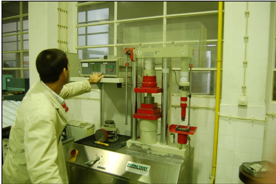
Figura 31 – Máquina de ensaio à compressão dos provetes cilíndricos.
