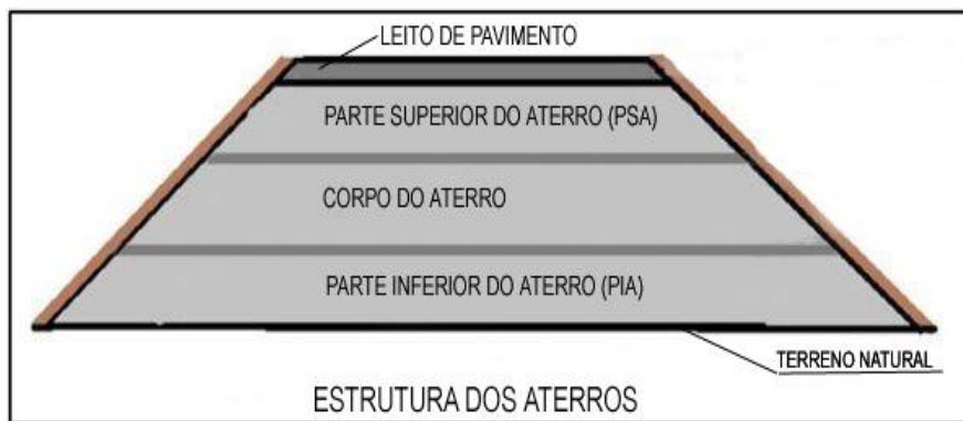
Figura n.º 2: Estrutura dos aterros
