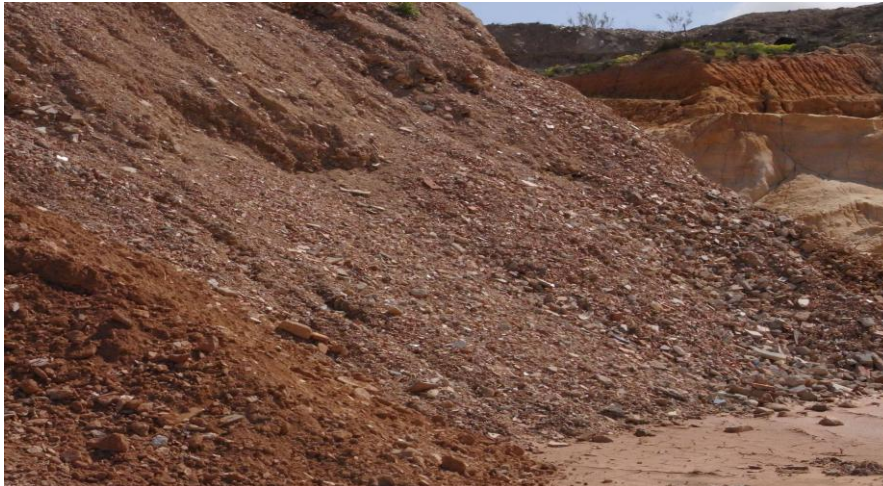
Figura 5 – Stocks de RCD antes do processamento no Centro de Gestão de Resíduos Arvela
