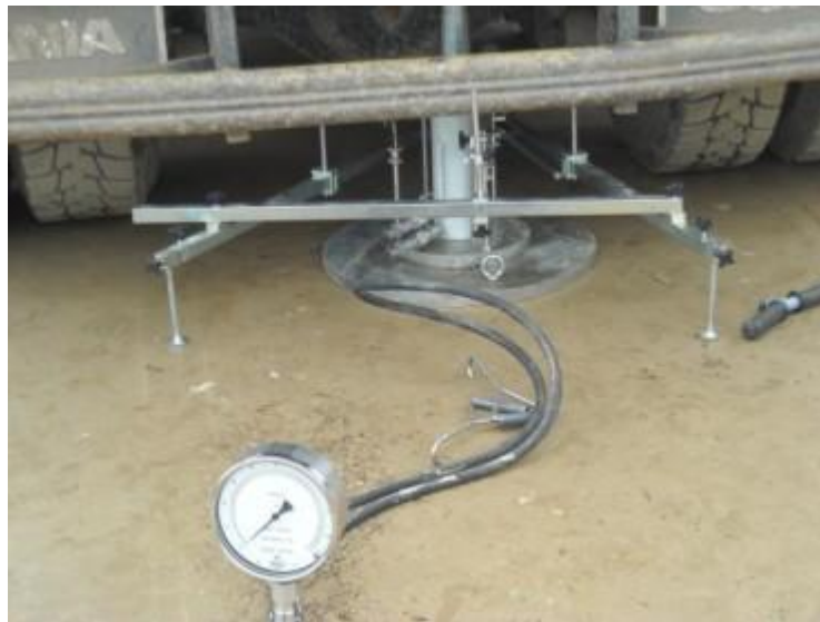
Figura 14 – Ensaio de carga com placa
