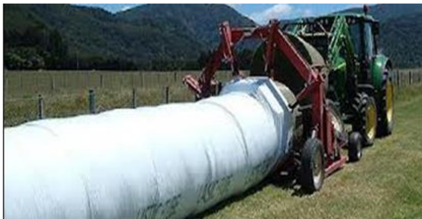
Figura 5 – Silo tubo (tipo salsicha) e máquina de enchimento
