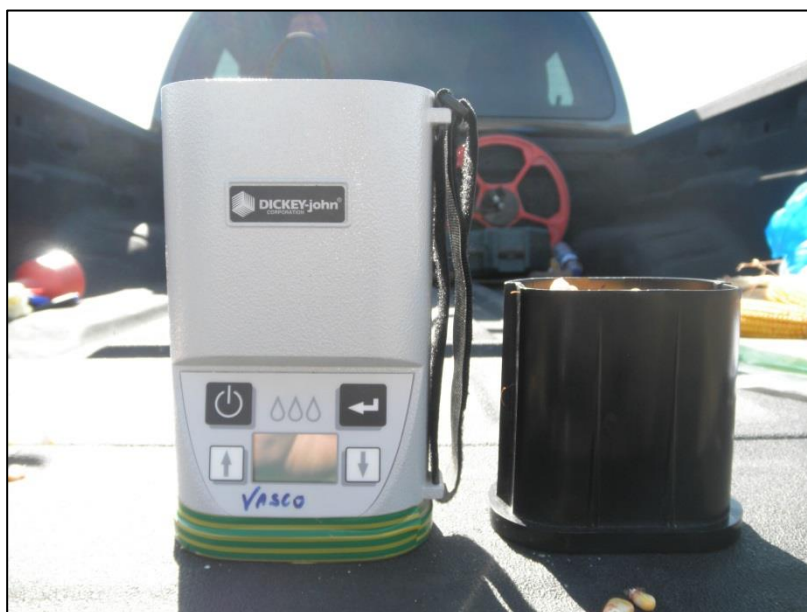
Figura 8 – Medidor de humidade da marca DICKEY-Jonh Fonte: Própria
