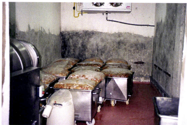
Fotografia 4 – Carros em aço inoxidável com massas de carne a maturar em câmara refrigerada.
