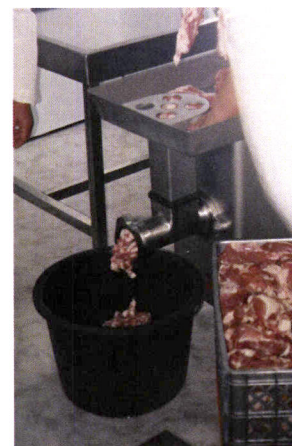
Fotografia 2 – Pormenor da miga de carnes com recurso a uma cortadora mecânica.
