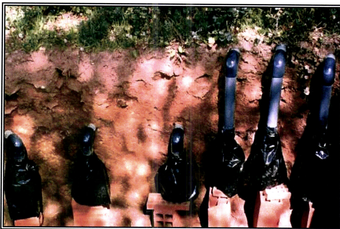
Figura 2.2.4 Aspecto parcial da parcela II, com destaque para os dispositivos de colheita de solução de solo por gravidade.
