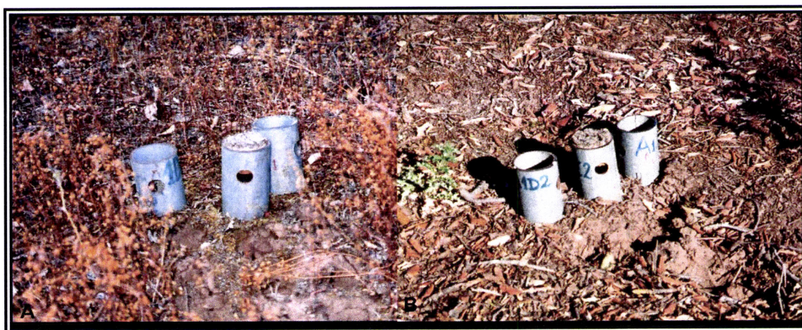
Figura 2.2.9 Aspecto parcial da parcela III, com destaque para dois conjuntos de tubos utilizados na mineralização sequencial in situ , nas áreas fora da acção da copa das árvores (A) e do sob coberto (B). É identificável na imagem o tubo com a extremidade coberta, ao centro, situando-se à sua direita o tubo que era colhido de imediato, e à sua esquerda o tubo com a extremidade descoberta, e que permanecia a incubar.
