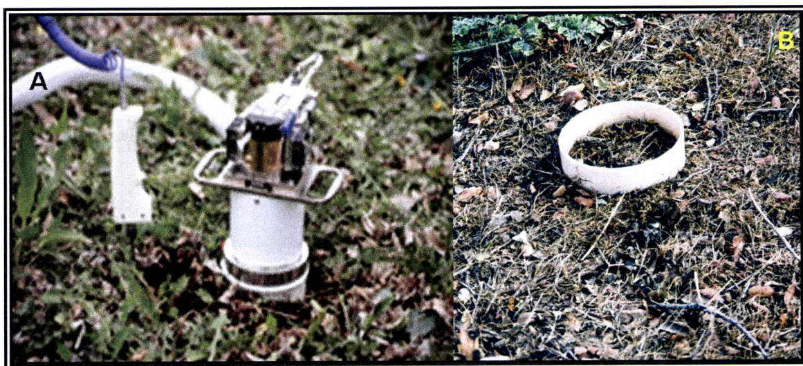
Figura 2.2.10 Aspecto parcial da parcela III, com destaque para a câmara de solo modelo 6400-09 (A) e para o anel de PVC (B), utilizados na medição do efluxo de CO 2 do solo
