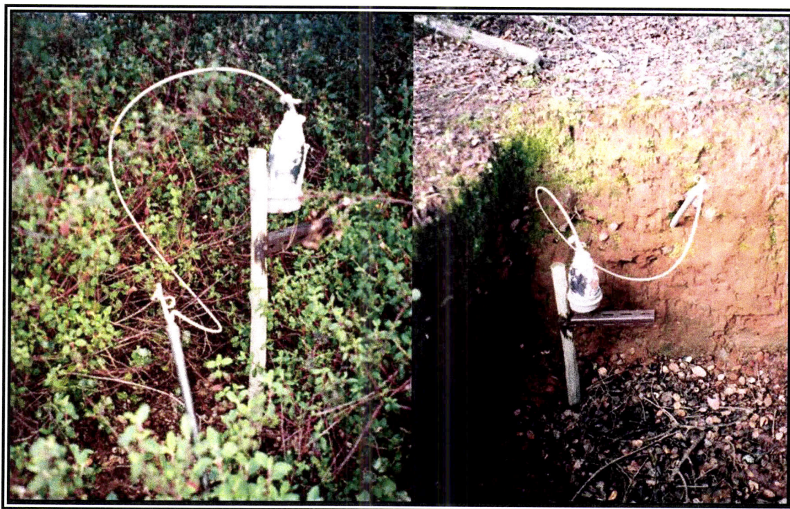
Figura 2.2.5 Aspecto parcial da parcela II, com destaque para os dispositivos de recolha de solução de solo por sucção.
