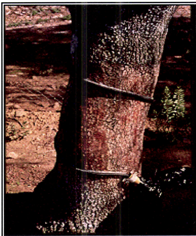
Figura 2.2.3 Aspecto parcial da parcela I, com destaque para o dispositivo de recolha do escorrimento ao longo do tronco.
