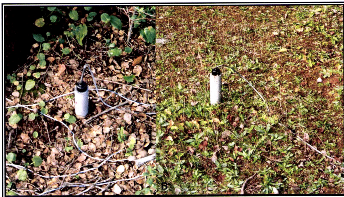
Figura 2.2.7 Aspecto parcial da parcela II, com destaque para duas sondas theta-probe da Delta-T, utilizadas na medição da humidade do solo, na área sob o coberto arbóreo (A) e na área fora da acção da copa das árvores (B).
