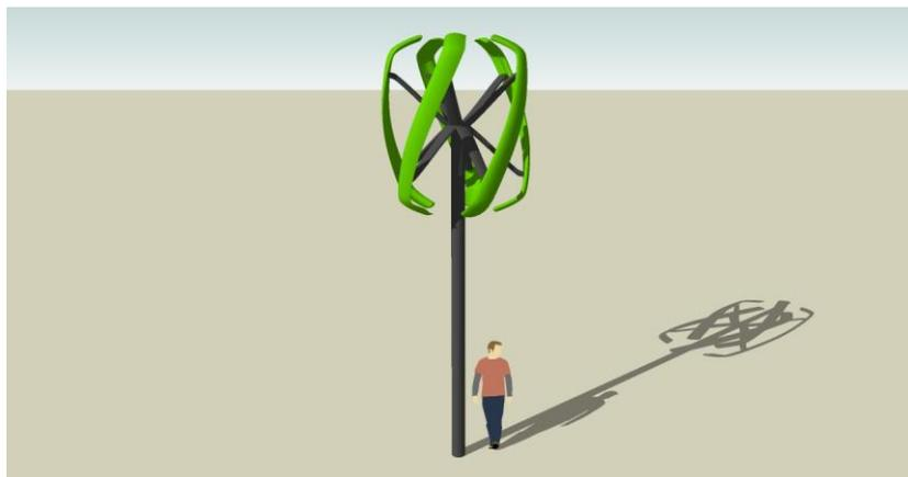
Figura 3.14 - Aerogerador com corpo da pá com forma helicoidal.
