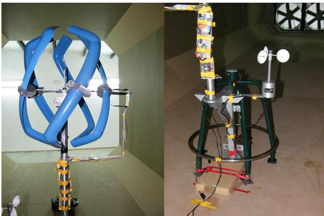
Figura 6.28 - Terceiro teste: sensores incorporados na torre.
