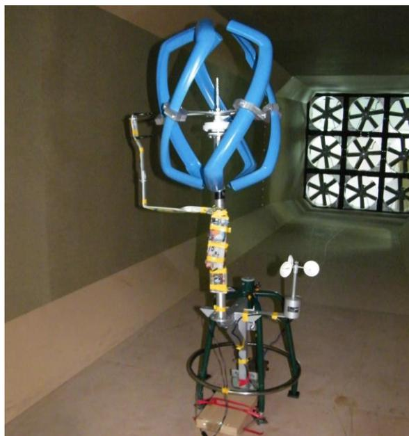
Figura 3.28 - Nova torre com o aerogerador e ligação de sensores.
