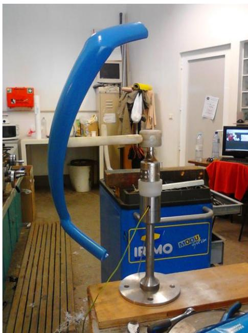
Figura 6.2 – Modificações feitas ao protótipo para acoplar o segundo GCCIP.
