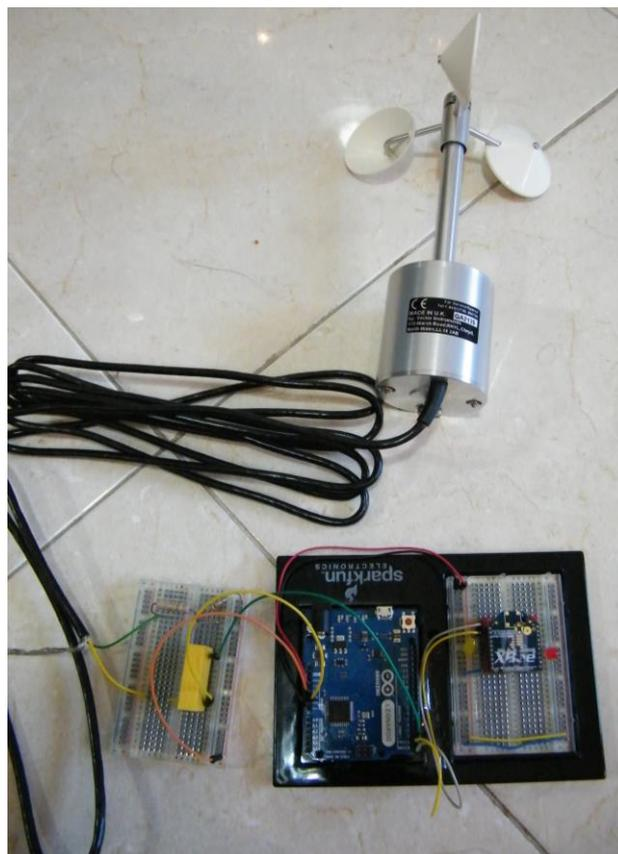
Figura 6.34 - Arduino com anemómetro.
