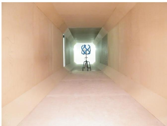
Figura 3.25 - Protótipo no túnel de vento da Universidade da Extremadura.
