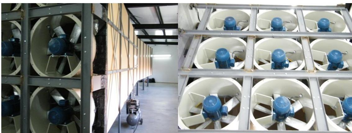
Figura 6.20 - Configuração do túnel de vento - Ventiladores.
