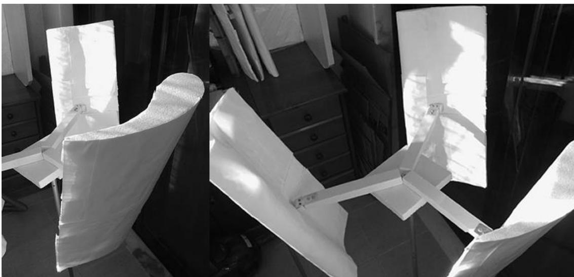
Figura 2.35 - Primeira turbina criada com pás em polietileno expandido.
