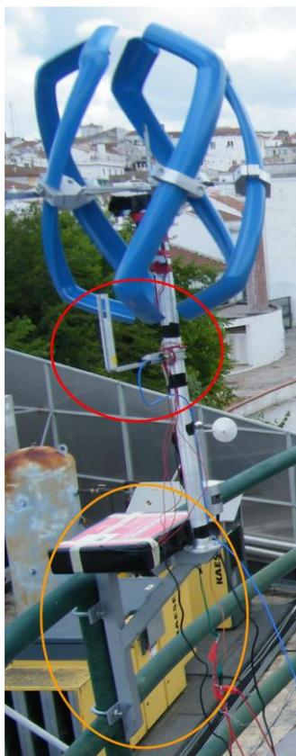
Figura 6.15 - Suporte do acelerómetro e circuitos elétricos.
