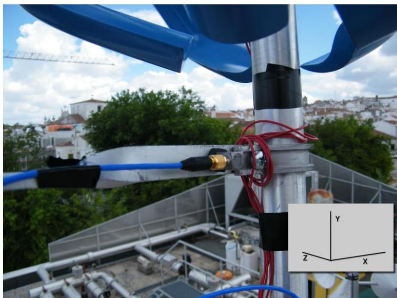
Figura 6.6 - Acelerómetro do sensor de vibrações.
