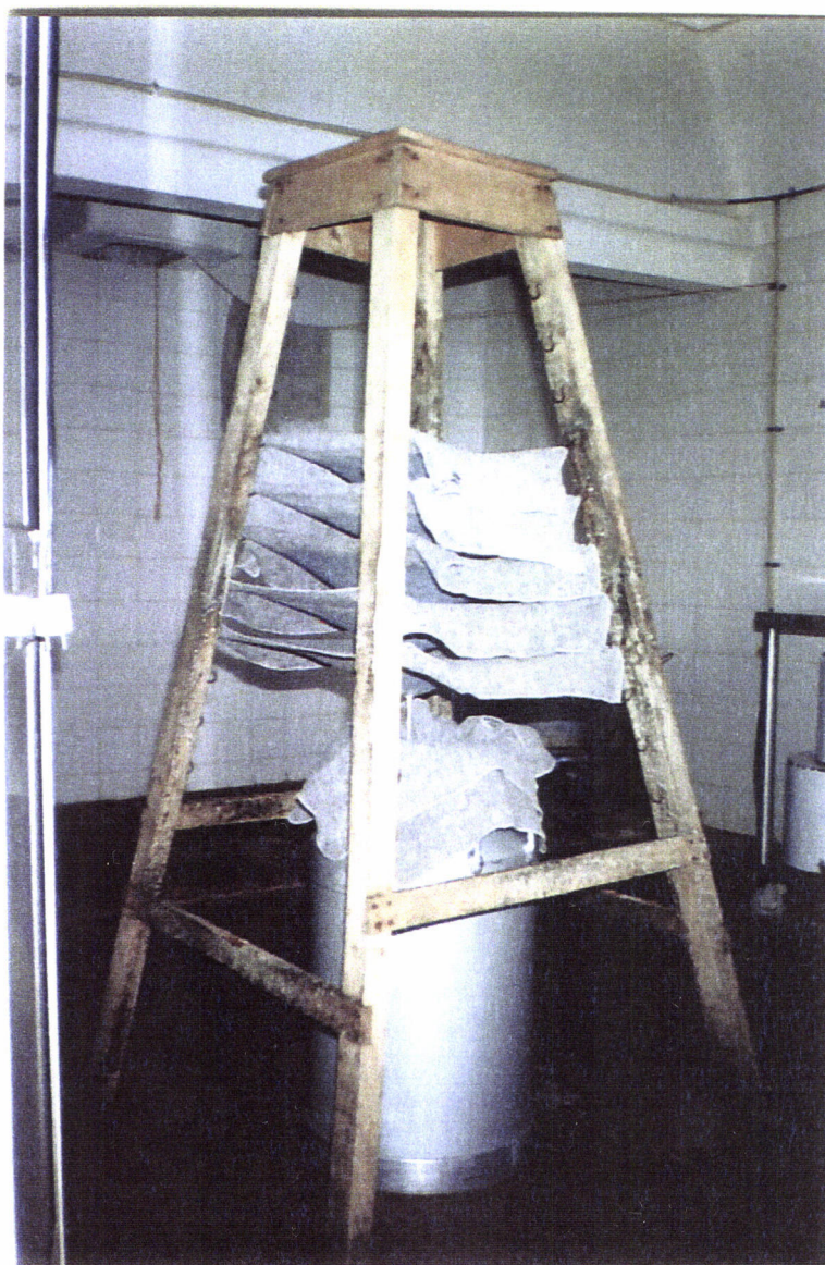
FOTO I-1 - "Coadora". Dispositivo Utilizado para a Filtração do Leite na Queijaria.
