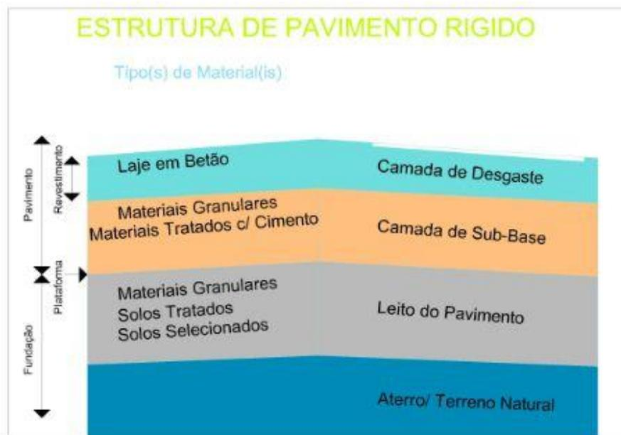
Figura n.º 9 - Pavimento tipo rígido
