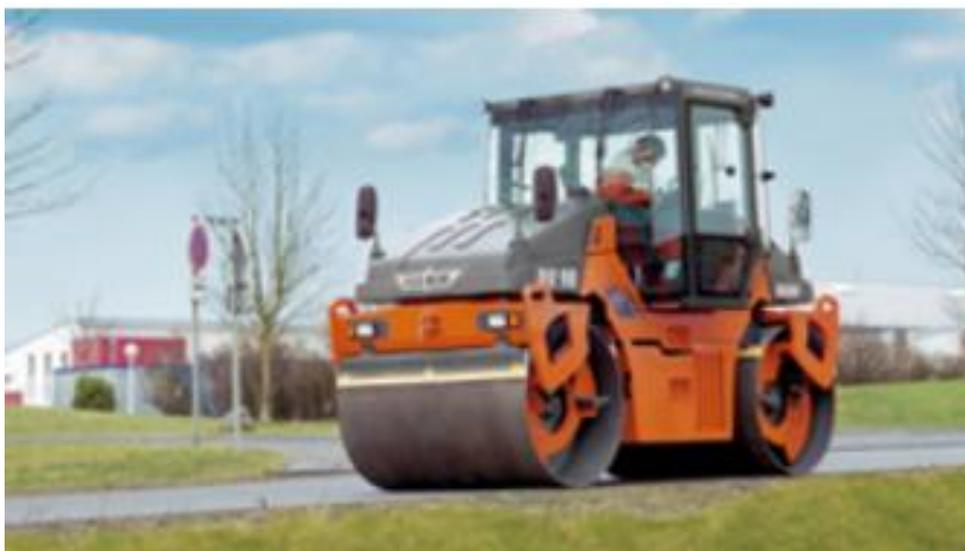
Figura n.º 41 - Cilindro de rolos, equipamento a ser utilizado após o pavimento estar reciclado <sup>14</sup>
