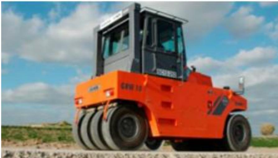
Figura n.º 40 - Cilindro de pneus, equipamento utilizado após a utilização da motoniveladora <sup>13</sup>
