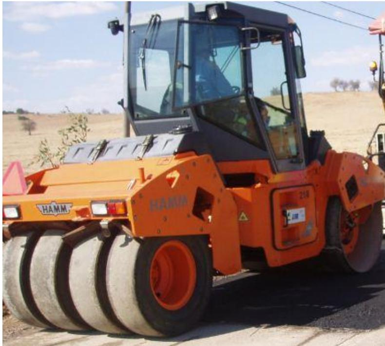
Figura n.º 30 - Cilindro misto (pneus e de rolo)
