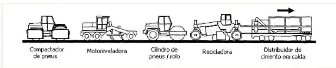
Figura n.º 38 - Sequência de equipamento para a execução dos trabalhos de reciclagem *in situ* a frio com cimento (Gomes, 2009)
