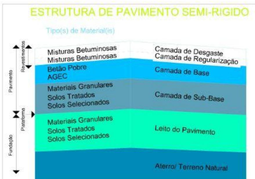
Figura n.º 8 - Pavimento tipo semi-rígido
