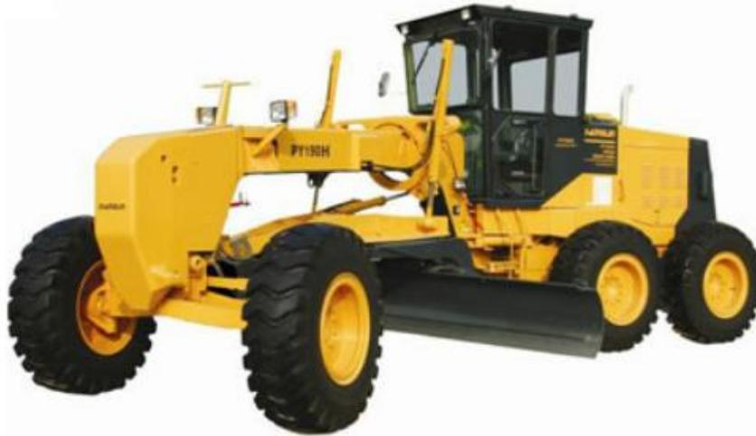
Figura n.º 39 - motoniveladora, equipamento utilizado após compactação do pavimento reciclado pelo cilindro de rolos, para regularização e nivelamento do pavimento, Changlin, Motoniveladora PY190H <sup>12</sup>
