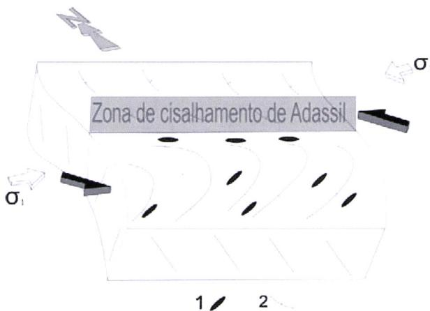
Figura IV.39- Modelo estrutural proposto para o sector estudado durante a primeira fase de deformação sin-xistosa em regime transpressivo esquerdo com fenómenos de partição da deformação. Trajectórias da deformação finita; 1. estiramento; 2. xistosidade.
