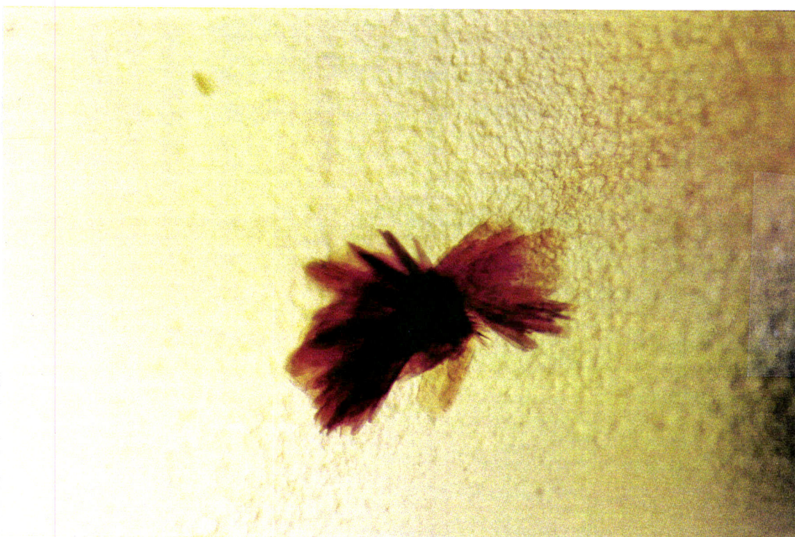
Figura IIA.5. Cristal múltiplo obtido na presença de ferricianeto de potássio a 4^\circ \text{ C} utilizando PEG 6 000 em substituição de PEG 4 000.
