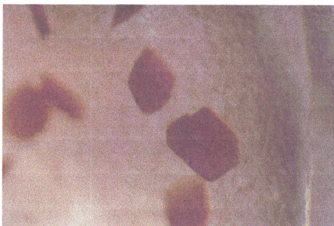
Figura IIA.7. Placas irregulares crescidas na presença de ascorbato de sódio a 4°C após perturbação da gota durante o processo de cristalização (dimensões máximas 0.4 x 0.4 x 0.2 mm).
