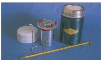
A experiência poderá ser realizada com outro objecto metálico, por exemplo, de latão. Com o material indicado, é possível determinar valores que apresentem um desvio menor do que 10 % em relação aos tabelados. Porém, se dispuser de calorímetros de qualidade (figura anexa), deverá utilizá-los em vez do material improvisado que foi sugerido.
