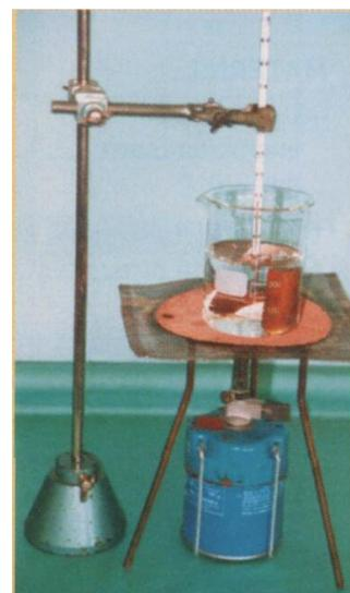
**2.** Para **determinar a capacidade térmica mássica do cobre**, vamos aquecer o objecto de cobre e colocá-lo dentro do calorímetro, que deverá ter uma determinada quantidade de água.
