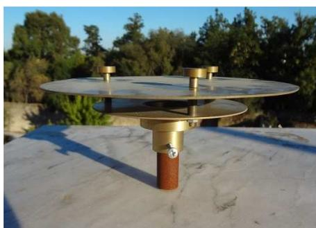
**Figura 14** – Imagem do *“Passive Aerosol Sampler Type A, Flat plates”*.
