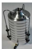
Figura 16 – *Cascade Impactor* usado na amostragem das duas campanhas intensivas: mês de agosto e mês de fevereiro (Adaptado de Fauser, 1999).
