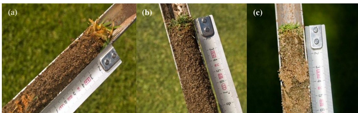
Figura 25: Medições da espessura do thatch nos roughs (a), fairway (b) e green (c) do buraco 9. E análise dos diferentes tipos de solo.
