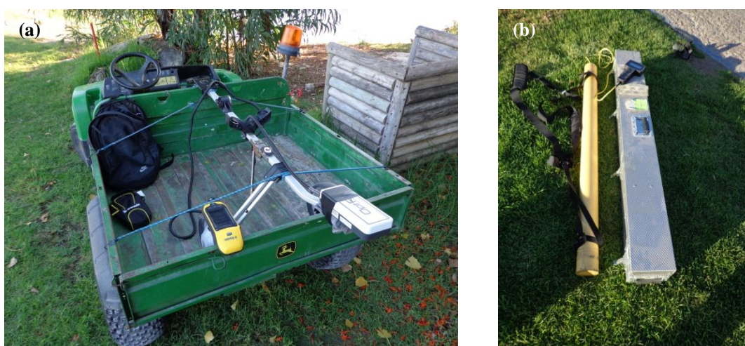
Figura 9: (a) Utilitário Gator adaptado para o transporte do sensor OptRx, modelo ACS430, sincronizado com um GPS Trimble Geoexplorer 6000 series , GeoXH. (b) sensor de indução eletromagnética DUALEM-1, utilizado nas medições de CEa.
