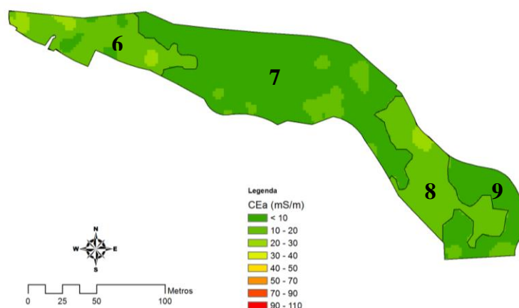
Figura 19: Carta de condutividade elétrica aparente (CEa) do buraco 8. Zonas homogêneas de tratamento (6, 7, 8 e 9) delineadas com base na CEa.
