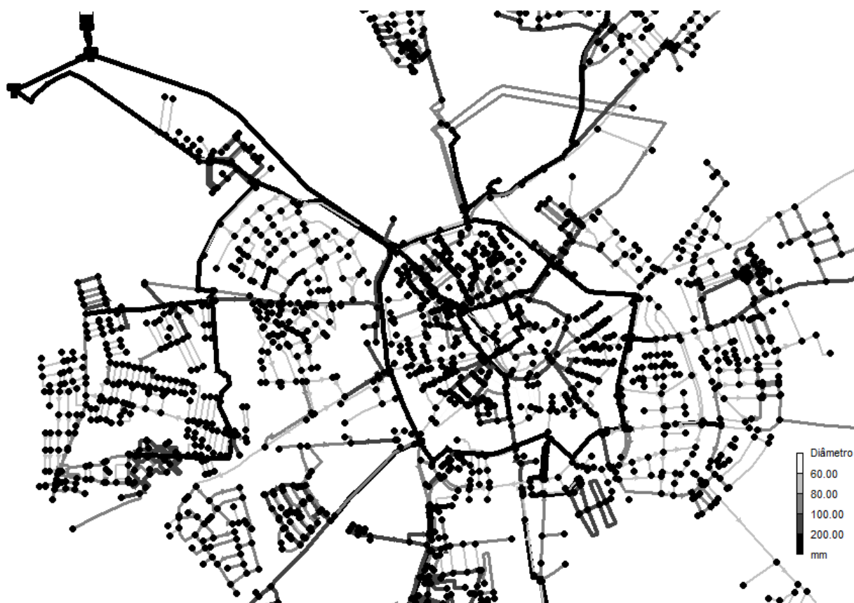
Figura 8 – Localização das gamas de diâmetros da rede de distribuição de água a Évora.
