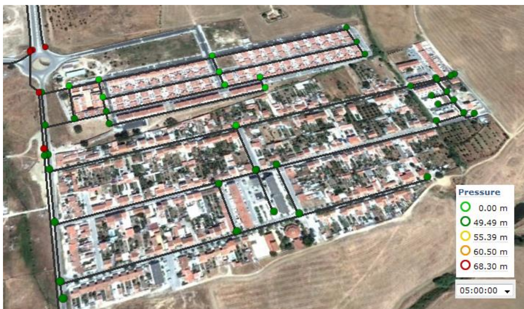
Figura 72 – Resultados das pressões em Bairro de Almeirim após a instalação da VRP.
