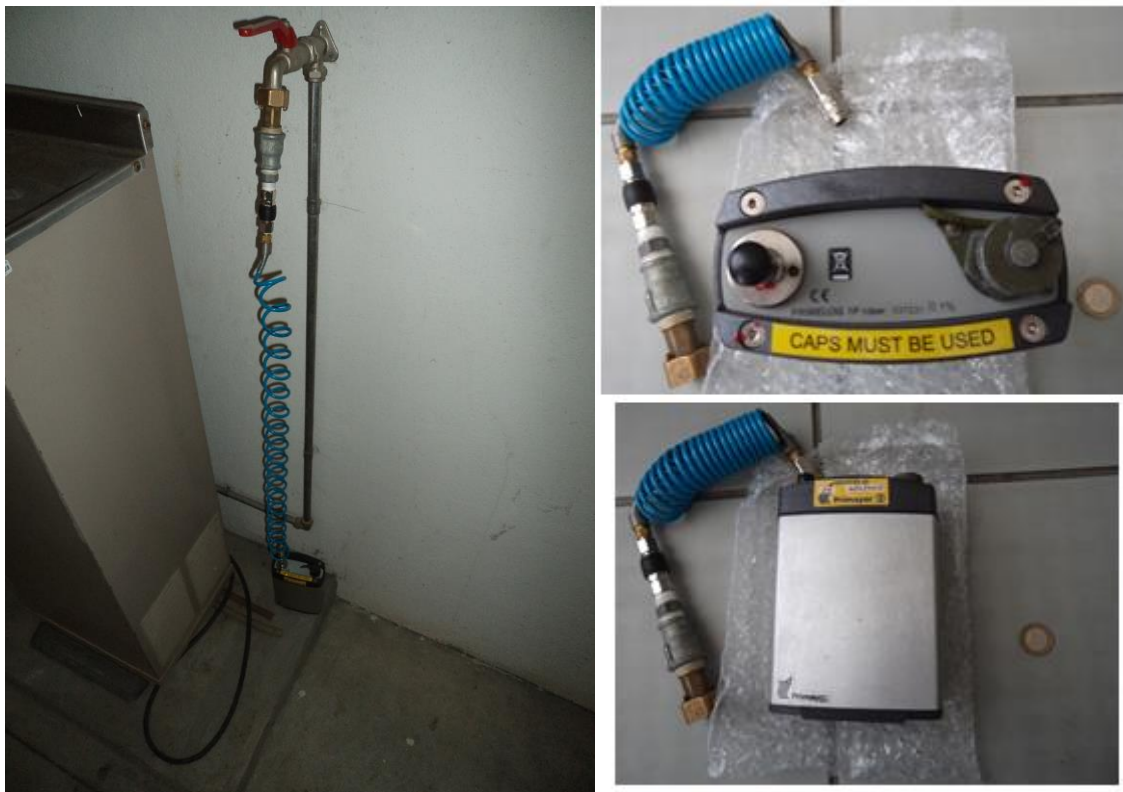
Figura 13 – Manómetro com Datalogger para medição de pressão e exemplo de aplicação.
