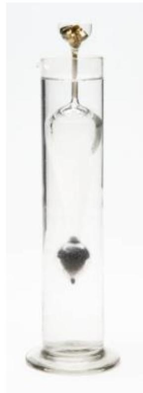
**MODO DE OPERAÇÃO:** Determinar a massa do areómetro,  $m$ , numa balança. Mergulhar o instrumento em água e colocar massas marcadas,  $m'$ , na tigela até o ponto de afloramento atingir o nível de água. A massa do volume de água deslocado é igual à soma da massa do areómetro com o valor das massas marcadas, ou seja,  $m+m'$ . Repetir o procedimento no
