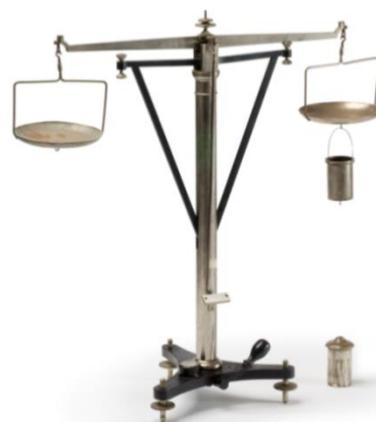
Fig. 11 - Balança hidrostática - J. Salleron (espólio da ESAG)
