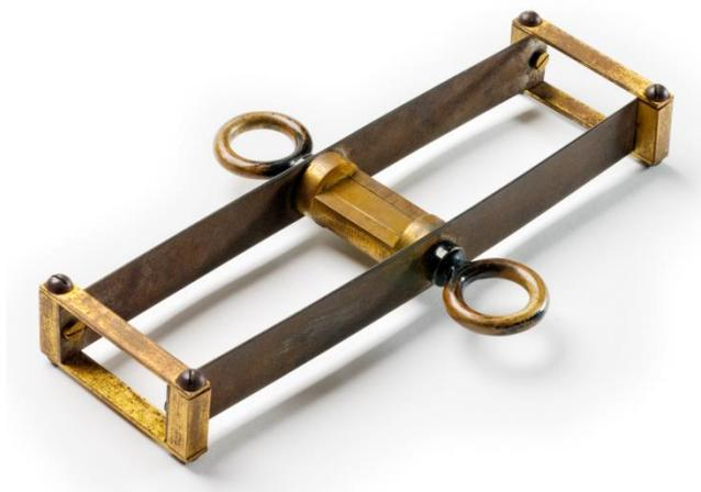
**FUNÇÃO:** Medição de intensidade de força
