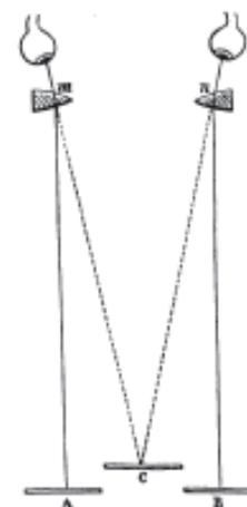
Fig. 234. — Marche des rayons dans le stéréoscope.
