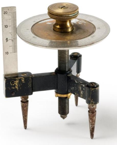
**DESCRIÇÃO:** Esferómetro niquelado constituído por um parafuso micrométrico enroscado num tripé cujas pontas formam um triângulo equilátero. O parafuso tem acoplado um disco graduado (0 até 500) na extremidade superior, e o tripé possui uma escala vertical graduada em milímetro (–10 mm a 20 mm).
