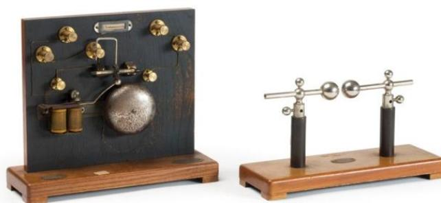
Fig. 28 - Emissor e recetor de ondas hertzianas - Max Kohl A. G. (espólio da ESAG)
