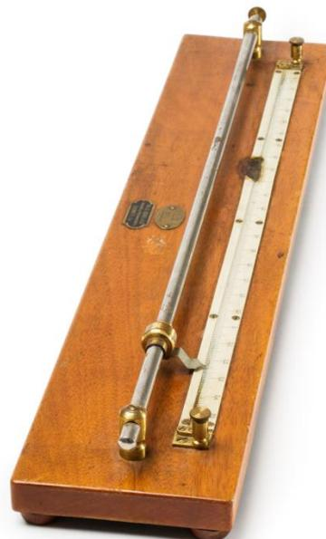
**MODO DE OPERAÇÃO:** Substituir duas resistências do circuito de Wheatstone pela ponte de fio e movimentar o cursor até o galvanómetro marcar zero. Medir na escala graduada os valores das resistências  $R_3$  e  $R_4$  correspondentes aos respetivos troços a e b de fio. Sendo  $R_1$  a resistência a determinar
