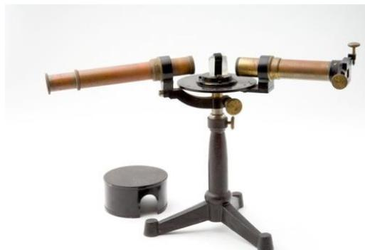
Fig. 30 - Espetroscópio - E. Leybold's Nachfolger (espólio da ESAG)
