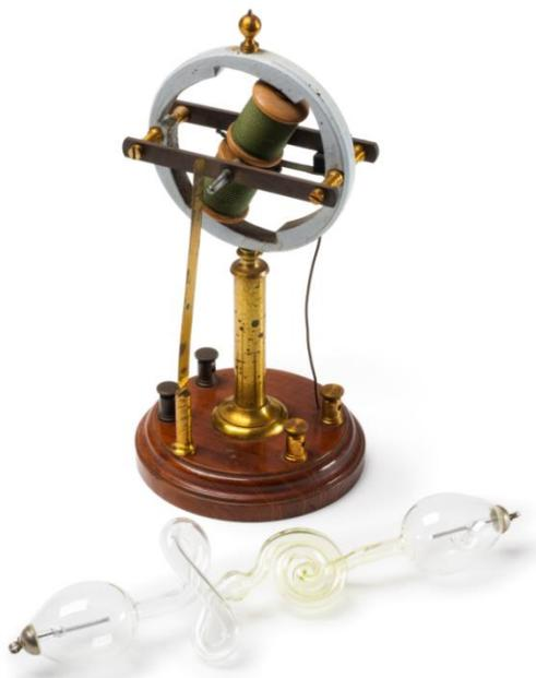
**FUNÇÃO:** Transformador de alta voltagem para utilizar com tubos de Geissler
