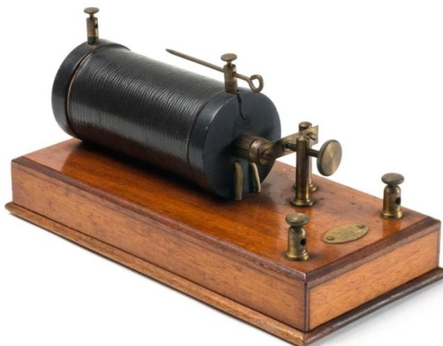
**FUNÇÃO:** Obter corrente de tensão elevada e intensa, por indução
