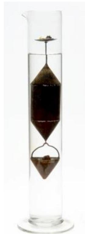
**MODO DE OPERAÇÃO:** Mergulhar o areómetro em água e colocar massas marcadas,  $m$ , vulgarmente chamadas de pesos, no prato superior para submergir o instrumento até alinhar o traço de referência com a superfície livre da água. Substituir as massas marcadas pelo corpo em estudo e completar com outras massas marcadas,  $m'$ , até
