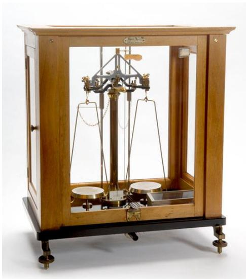
**DESCRIÇÃO:** Balança de alta precisão, com caixa de mogno envidraçada, sistema de correntes e pratos dourados
