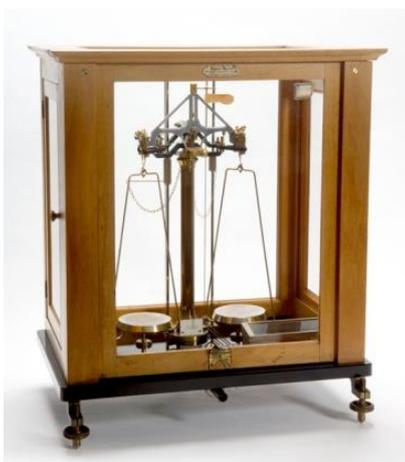
Fig. 34 - Balança de precisão com sistema de correntes
