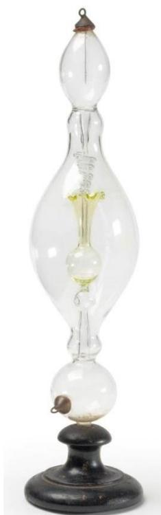
**DESCRIÇÃO:** Tubos de vidro com diferentes formas e comprimento variável, em que uns são parcialmente construídos com vidro de urânio (secção amarelo-esverdeado) e outros possuem um reservatório cilíndrico com um líquido fluorescente, que contribuem para embelezar o efeito produzido. Cada tubo contém um gás rarefeito, e em cada uma das extremidades fechadas existe um elétrodo de platina, soldado ao vidro, que a atravessa. Um dos exemplares assenta numa base de madeira.
