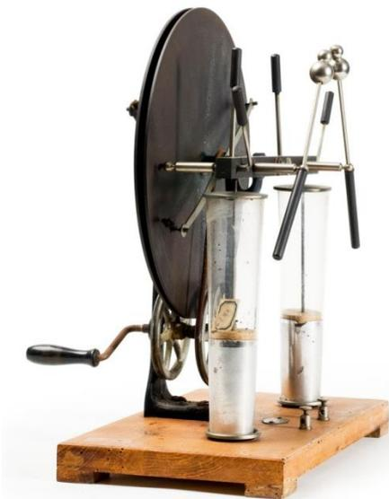
**FUNÇÃO:** Gerador mecânico de corrente elétrica em alta tensão, por indução
