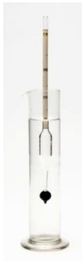
**MODO DE OPERAÇÃO:** Mergulhar o densímetro no líquido contido numa proveta, sem que toque nas paredes ou no fundo. A medição é feita na escala pela superfície de afloramento (corresponde à zona de contacto entre a superfície do líquido e o densímetro).
