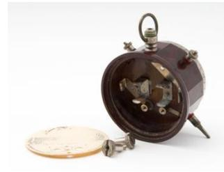
**MODO DE OPERAÇÃO:** Como voltímetro é montado em paralelo no circuito elétrico, enquanto como miliamperímetro é montado em série.
