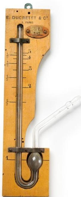
**FUNÇÃO:** Medir a tensão de gases e vapores comprimidos
