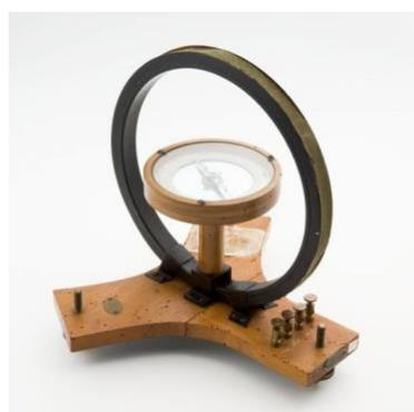
Fig. 26 - Bússola das tangentes - Max Kohl A. G. (espólio da ESAG)
