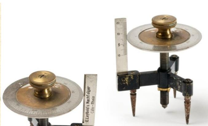
Fig. 32 - Esferómetro - E. Leybold's Nachfolger (espólio da ESAG)
