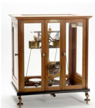
Fig. 35 - Balança de precisão aperiódica
