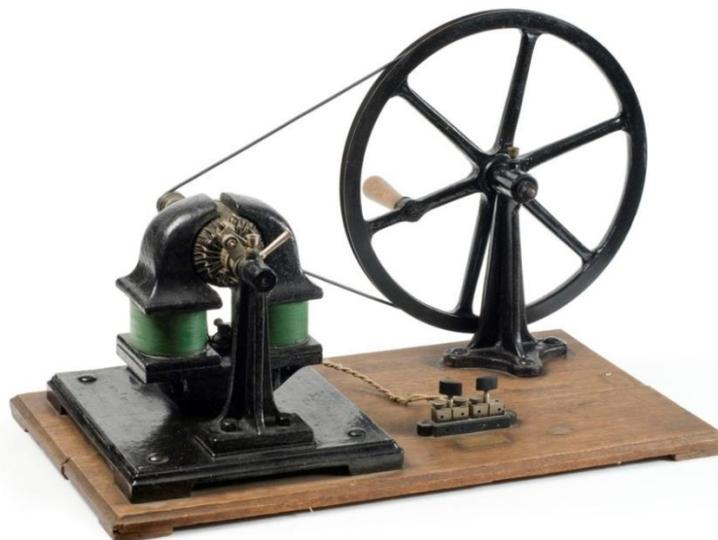
**FUNÇÃO:** Gerador de corrente elétrica contínua
