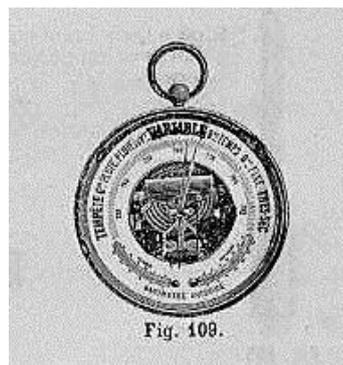
Fig. 18 - Barómetro aneroide - Les Fils D'Émile Deyrolle (catálogo de 1907, p.24)
