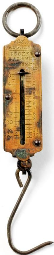
**FUNÇÃO:** Medição de intensidade de força
