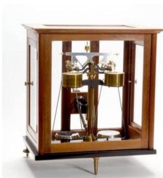
**MODO DE OPERAÇÃO:** O procedimento mais utilizado em laboratório para medir a massa de um objeto com a balança de precisão é o processo da tara. Colocar o corpo no prato direito, e no outro prato colocar uma tara (por exemplo, uma massa marcada), que se mantém durante a operação, de massa superior ao objeto. Adicionar massas marcadas  $m'$  ao prato que contém o corpo de modo a que o fiel da balança oscile na parte média da escala; determinar o ponto de paragem  $n$  (média aritmética
