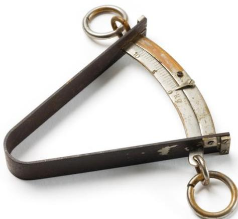
**FUNÇÃO:** Medição de intensidade de força
