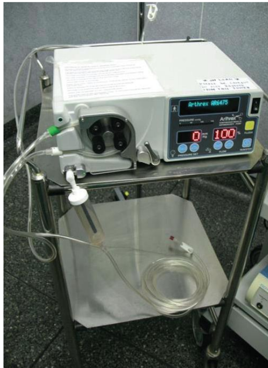
Figura 22. Bomba de fluidos, sistema peristáltico (segundo Owen, 2012).
