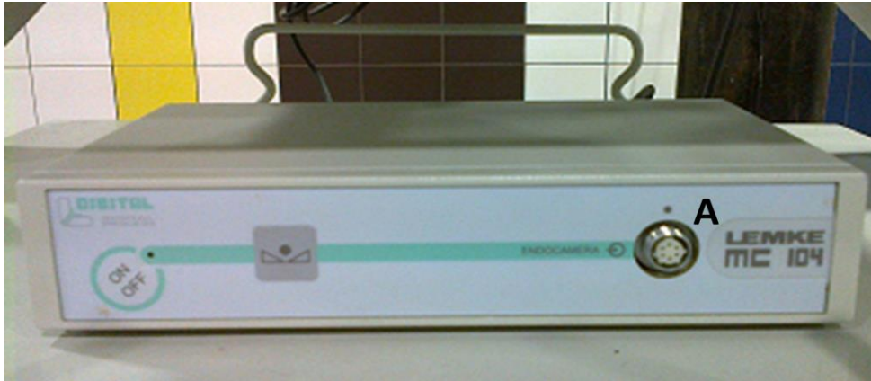
Figura 13. Caixa de controlo de artroscopia. A, entrada para cabo de conexão entre a cabeça da câmara e a caixa de controlo (imagem gentilmente cedida pelo Hospital Veterinário do porto).
