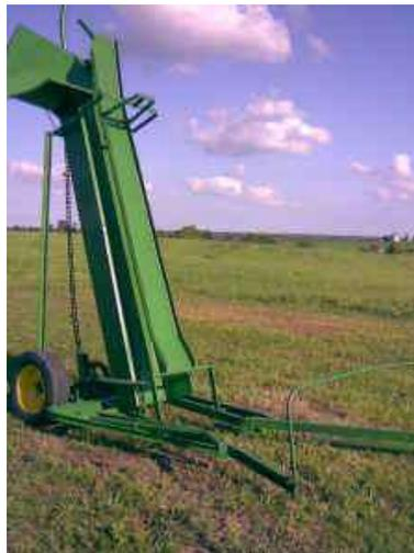
Fig nº 27 – Carregador de fardos de plano inclinado
