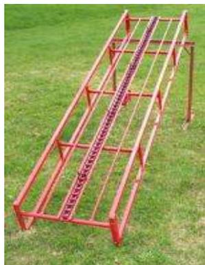
Fig nº 31- Rampa transportadora de fardos
