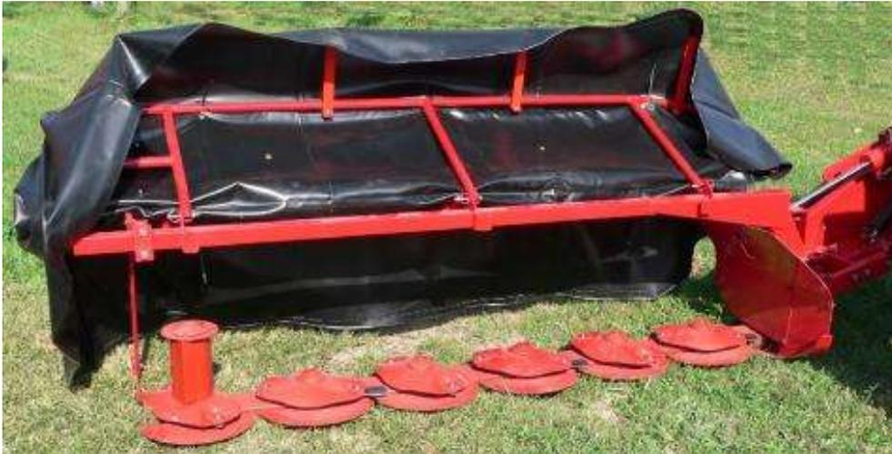
Fig nº 8 - Gadanheira rotativa de eixo vertical de discos
