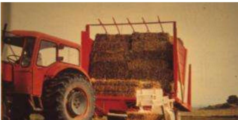
Fig nº 29 - Reboque autocarregador de fardos
