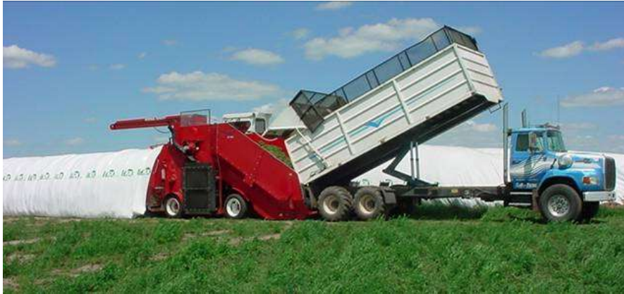
Fig. 68 - Superfície do solo bem drenado e minimamente preparado é tudo o que é necessário para localizar um silo.
