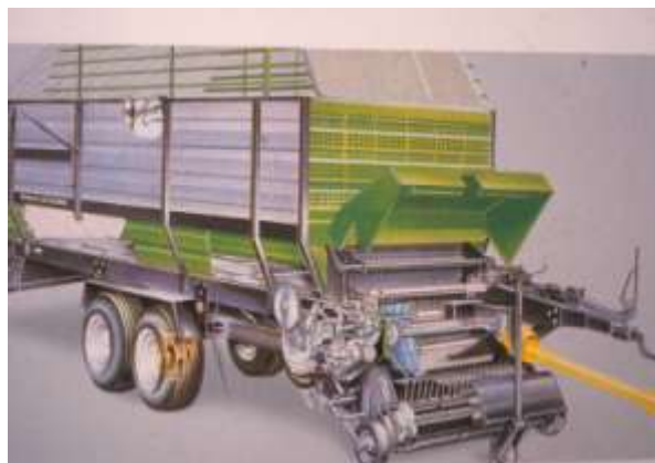
Fig. 34 - Os semi-reboques autocarregadores são metálicos com o “pick-up” c/ órgãos de corte, que dividem a forragem em troços curtos e fundo móvel.
