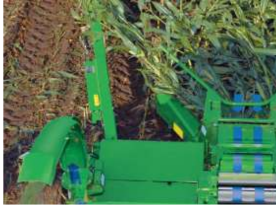
Fig. 25 - Dispositivo (tipo disco picador ventilador, ou tambor de facas helicoidais) para milho.
