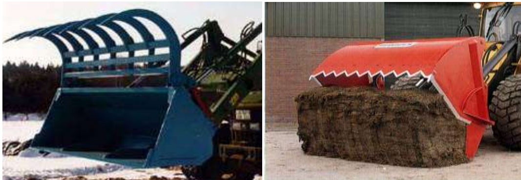
Fig 52 - Forquilhas e guilhotina hidráulica para desensilar aplicadas na pá frontal do tractor.
