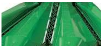
Fig. 22 - Bico colhedor preparado para ser utilizado em culturas de entrelinha larga (milho-forragem).
