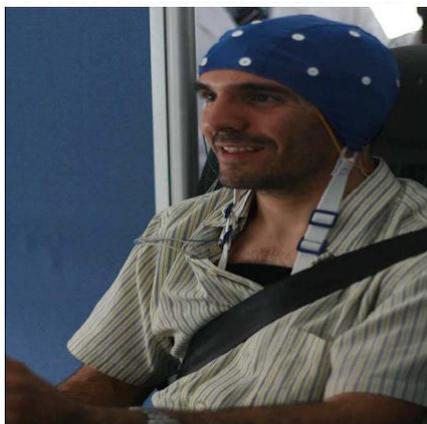
Figura 2.2: Utilização de um equipamento de EEG para medição do cansaço de um condutor, segundo [17].
