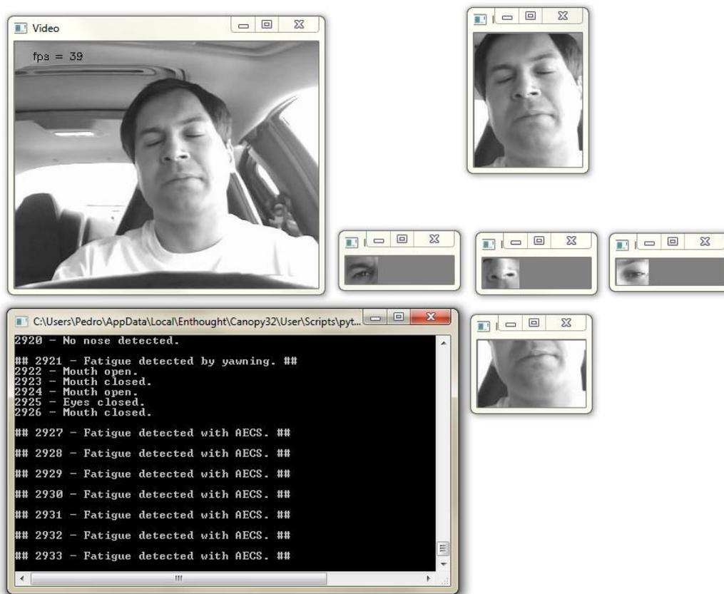
Figura 3.3: Exemplo do output do sistema em modo de depuração.
