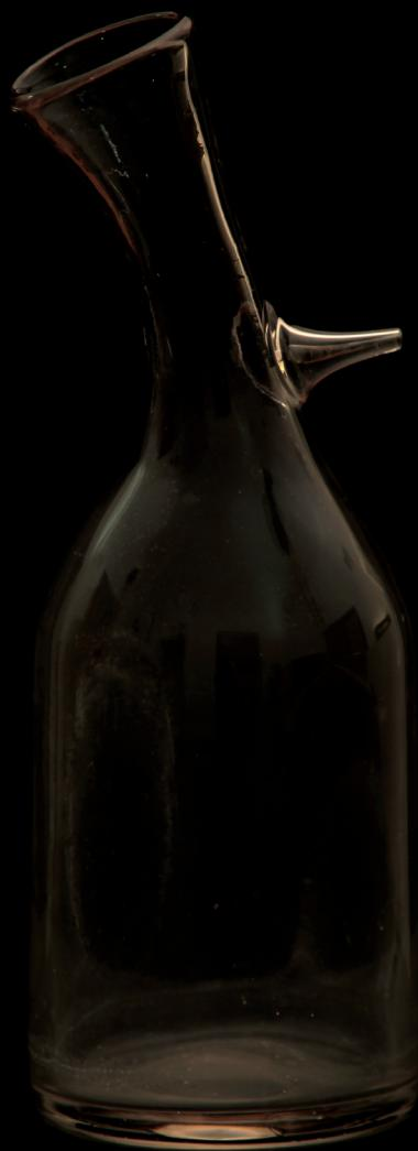
**Garrafa de vidro**, com gargalo encurvado e uma pequena tubuladura lateral, afilada na zona superior. Recipiente utilizado na manipulação de líquidos (referência a “garrafa de vidro com tubuladura” na Catalogação do Material do Gabinete de Química de 1917-1918)
