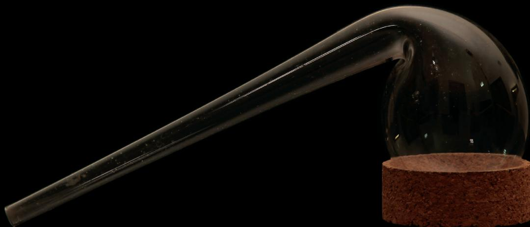
**Retorta de vidro**, vaso oblongo com uma abertura estreita e alongada na parte superior, inclinada para baixo, utilizado no processo de destilação (referência a “6 retortas grandes” no Inventário do Liceu Central de André de Gouveia de 1920)
