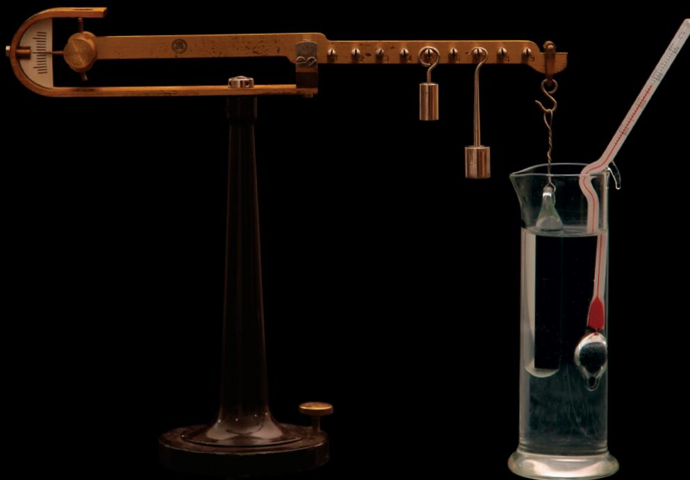
**Balança de Mohr-Westphal**, dispositivo usado para determinação de densidades de líquidos segundo o princípio de Arquimedes. O conjunto é composto pela balança metálica, imersor de vidro preso a um gancho por fio de platina suspenso do braço graduado apoiado num cutelo, termómetro, pinça, jogo de cavaletes e proveta. Fabricante: August Sauter, Ebingen - Alemanha (nº 151 do Inventário do Material do Gabinete de Física de 1949)
