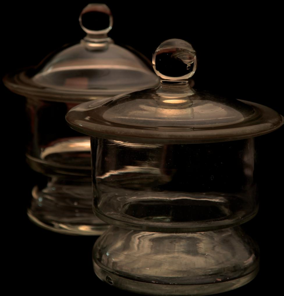
**Exsicadores**, recipientes em vidro, com tampa hermética, usados para armazenar substâncias em atmosfera com baixo teor de umidade, garantida pela presença de um agente exsiccante (por exemplo, sílica gel)
