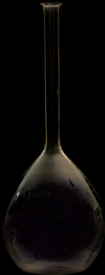
**Balão volumétrico**, recipiente de vidro aferido usado na preparação de soluções de concentração rigorosa
