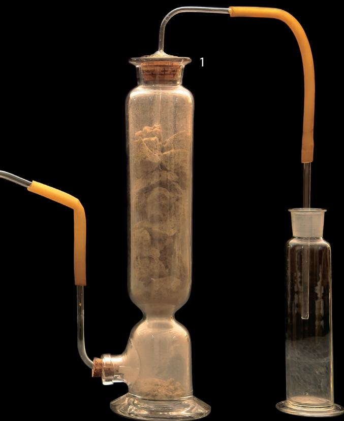
**1 Torre de secagem ou absorção**, recipiente cilíndrico de vidro composto de dois reservatórios interligados que tem como função a secagem de gases por ação de uma substância absorvente da humidade colocada no reservatório superior. (inventariada como "4 provetas para dissecar gases" na Catalogação do Material do Gabinete de Química de 1917-1918)
