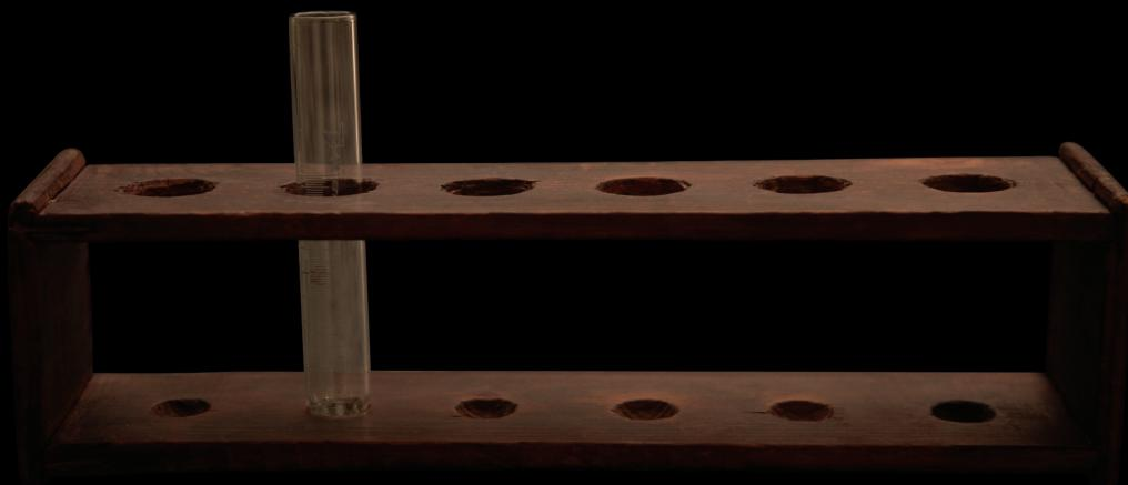
**Tubo de ensaio**, recipiente, em vidro, alongado e cilíndrico usado para efetuar reações químicas em pequena escala.
