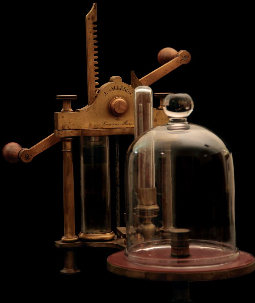
**Máquina pneumática**, bomba aspirante de duplo êmbolo constituída por dois tubos de vidro verticais no interior dos quais se deslocam os êmbolos que se movem verticalmente com movimento de uma manivela de dois braços. Utilizada para retirar o ar de recipientes de modo a obter baixas pressões no seu interior.
