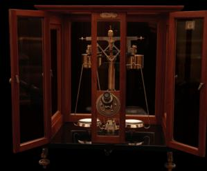
**Balança de alta precisão**, aperiódica, com caixa de mogno envidraçada, óculo e pratos platinados. Possui um sistema de amortecedores pneumáticos para atenuação das oscilações dos braços e permite a leitura direta, através do óculo, das últimas frações de massa sobre a escala. Fabricante: August Sauter, Ebingen - Alemanha (nº 48, Inventário do Material do Gabinete de Física de 1949)
