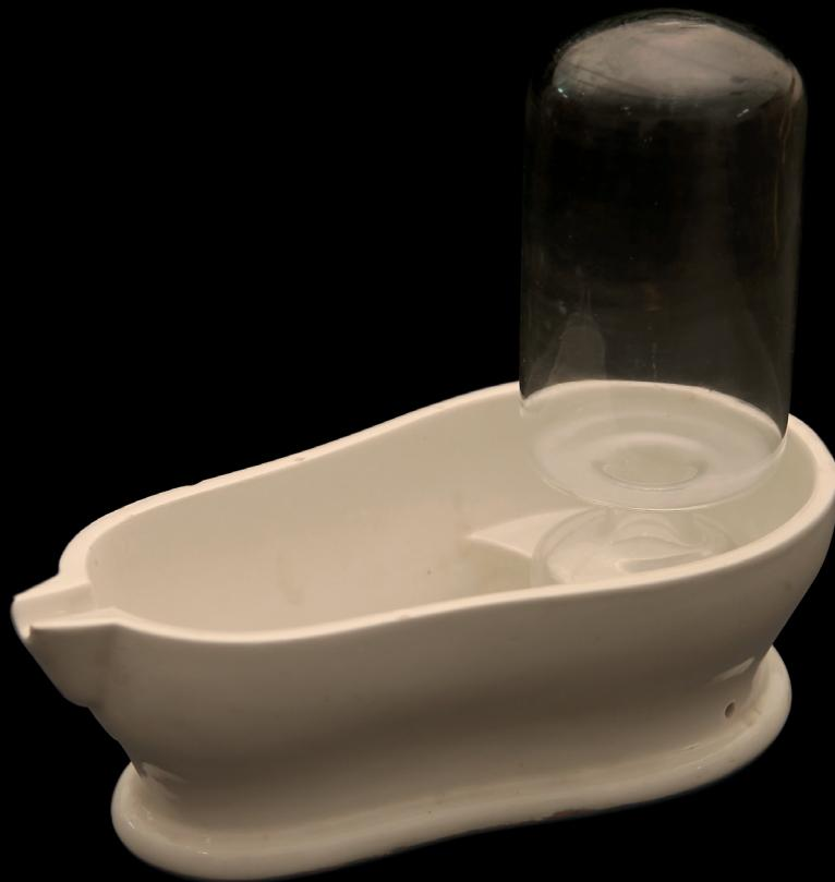
Tinas, reservatórios com a forma adequada onde se coloca o vaso, apoiado na posição invertida. Os gases são recolhidos por deslocamento de um líquido (mercúrio) contido na tina (referência a “1 tina de porcelana” e a “1 tina de barro escuro” na Catalogação do Material do Gabinete de Química de 1917-1918)
