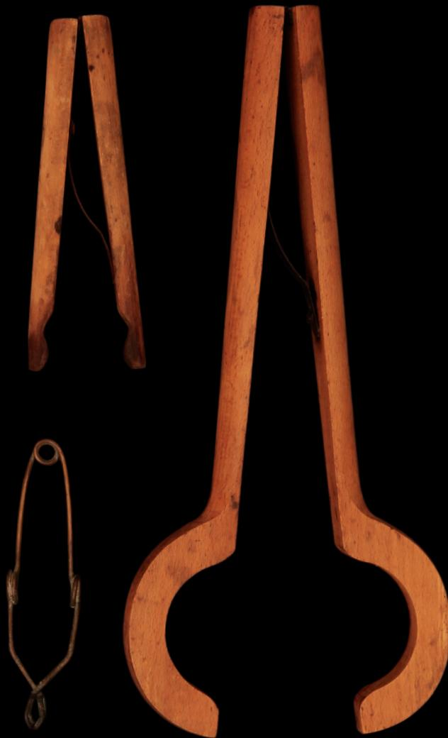
**Pinças de madeira e metal**, usadas na manipulação de objetos quentes. Pinças de madeira, com uma mola entre as duas hastes, para segurar tubos de ensaio e gargalos de balões. Pinça metálica com mola helicoidal numa extremidade, para segurar tubos de ensaio
