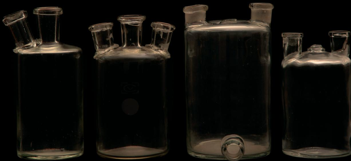
**Frascos de Woulfe**, frascos de vidro cilíndrico com duas ou três tubuladuras com a função de lavagem ou preparação de gases. A sua criação é atribuída ao químico irlandês Peter Woulfe (1727-1803). (Inventário do Material do Gabinete de Química de 1918-1919)
