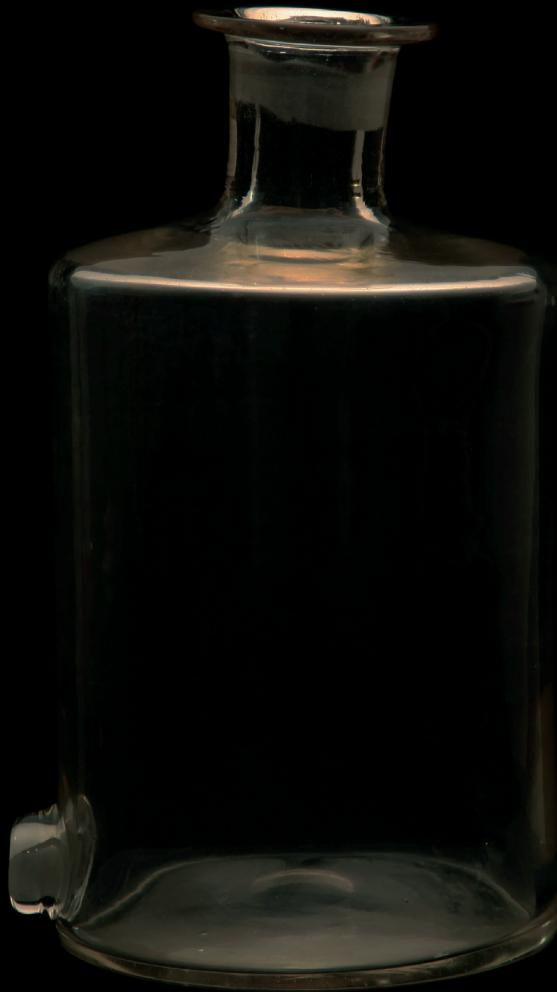
**Garrafa de Mariotte,** recipiente cilíndrico de vidro com duas aberturas, uma superior e outra lateral, de menor diâmetro, localizada perto da base. Na abertura superior adapta-se um tubo de vidro oco através de uma borracha ou cortiça perfurada que se mergulha no líquido contido na garrafa, o que permite obter uma velocidade constante de descarga de um fluido
