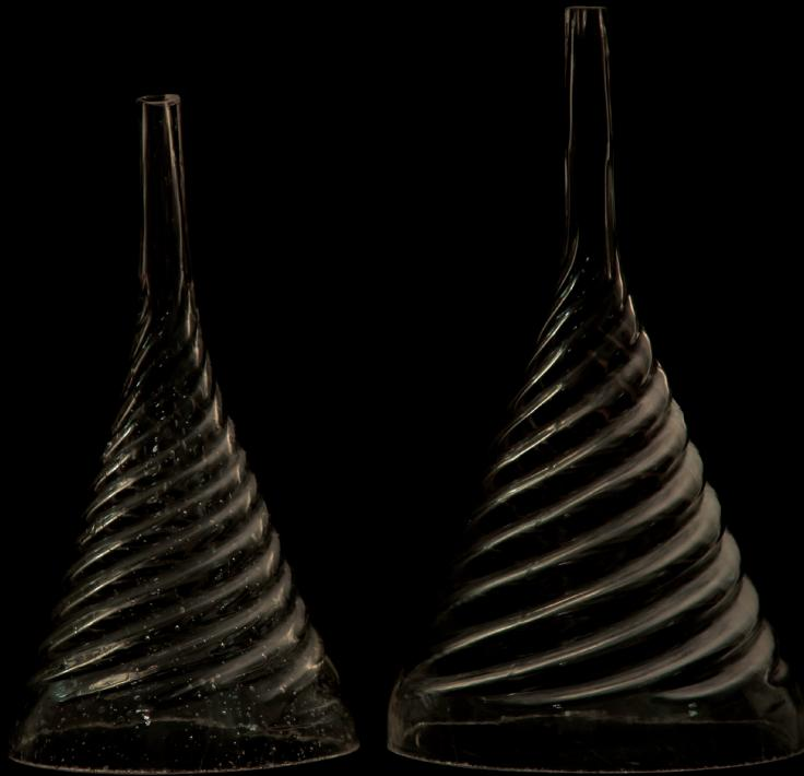
**Funis**, de vidro espesso com estrias helicoidais na superfície interna, usados em processos de filtração rápida
