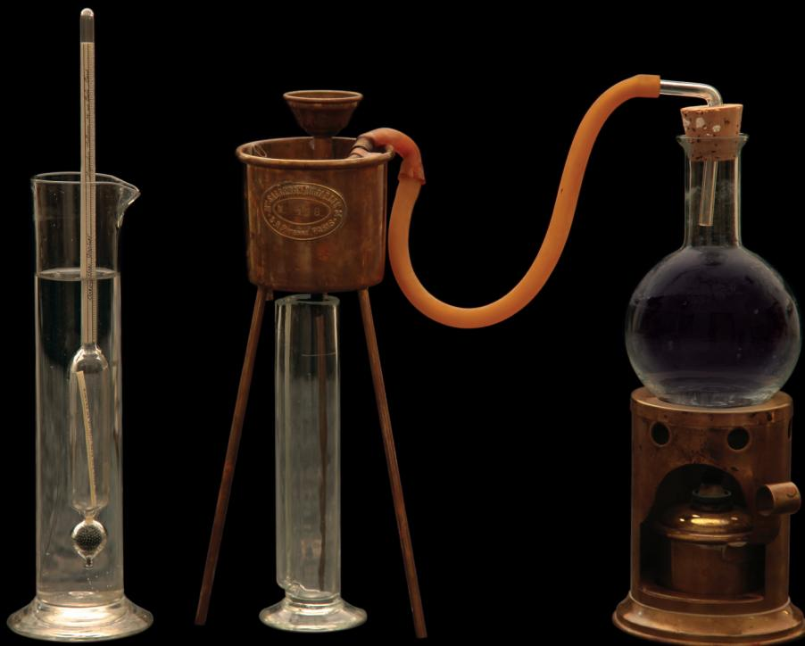
**Alambique Dujardin-Salleron** (pequena dimensão), aparelho de destilação usado para determinar a riqueza alcoólica de vinhos e outras bebidas espirituosas. Constituído por suporte em latão, para o balão de destilação, lamparina (fonte de calor), reservatório em latão montado em tripé, com serpentina e funil (sistema de arrefecimento/condensação), proveta de vidro (recolha do destilado), termómetro de mercúrio e alcoómetro. Fabricante: Dujardin-Salleron, Paris - França
