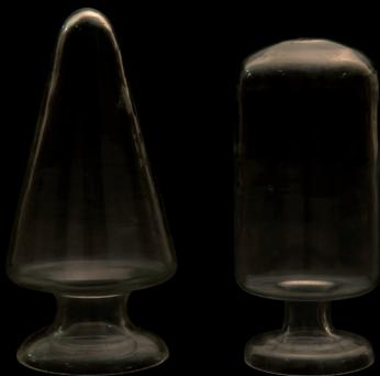
Vasos de vidro, usados na posição invertida para recolha de gases por deslocamento do líquido
