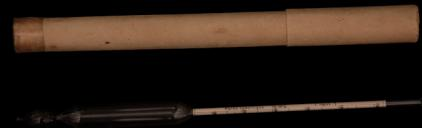
Densímetro, dispositivo usado para determinar a densidade de líquidos
