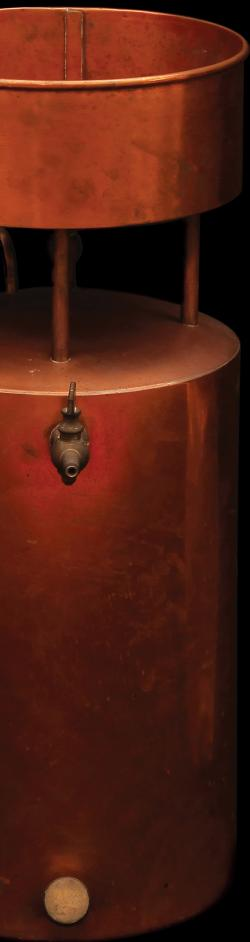
Gasómetro de cobre
