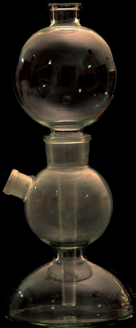
**Aparelho de Kipp,** equipamento em vidro usado para produção de gases obtidos através de uma reação química e criado em 1844 pelo holandês Petrus Jacobus Kipp (1808-1864). É constituído por um funil esférico com um colo longo e um reservatório vertical formado por dois elementos interligados. Os gases formam-se, por exemplo, pela reação entre um ácido adicionado pelo funil e um sólido contido no elemento intermédio
