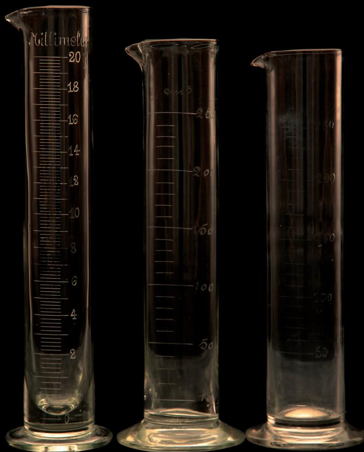
**Provetas**, vasos cilíndricos de vidro, com graduação, assentes em bases circulares. São utilizados para medir, de forma menos rigorosa, volumes de um líquido (referência a "1 Proveta graduada de 250 cc" e "6 Provetas de vidro" na Catalogação do Material do Gabinete de Química de 1918-1919)
