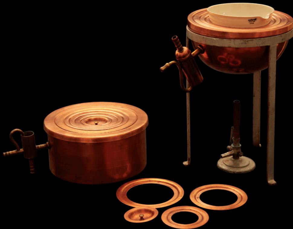
**Banhos-maria**, dispositivos, em cobre, utilizados no processo de aquecimento indireto por meio de água para que as substâncias possam ser aquecidas lentamente e de forma homogênea. São constituídos por um reservatório circular com nível de água constante, cinco anéis concêntricos para aberturas padronizadas e uma tampa
