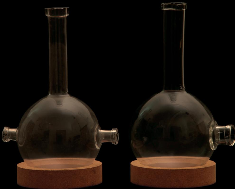
**Balões de fundo redondo com tubuladuras**, recipientes utilizados, nomeadamente, no processo de destilação para recolha do destilado (referência a “4 balões, não graduados, de fundo esférico com tubuladuras” na Catalogação do Material do Gabinete de Química de 1917-1918)
