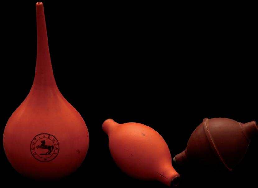
**Enchedor de pipeta** (pompete, pera ou pró-pipeta), bolbo de borracha, usado como bomba de sucção, destinado ao enchimento e esvaziamento de pipetas
