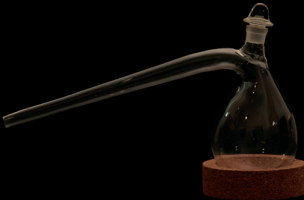
**Retorta de vidro** com abertura na parte superior, vaso oblongo com uma abertura estreita e alongada na parte superior, inclinada para baixo, utilizado no processo de destilação. A abertura superior permite a adaptação de um termómetro (referência a 6 retortas pequenas” no Inventário do Liceu Central de André de Gouveia de 1920)
