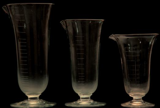
**Copos cónicos de vidro**, ligados por um pequeno pé a uma base circular de sustentação e graduados em grama. Utilizados para medir massas de água (referência à existência de “Copo graduado de 500 grammas” e “Copo graduado de 200 grammas” no Catálogo do Material do Gabinete de Física de 1920-1921)
