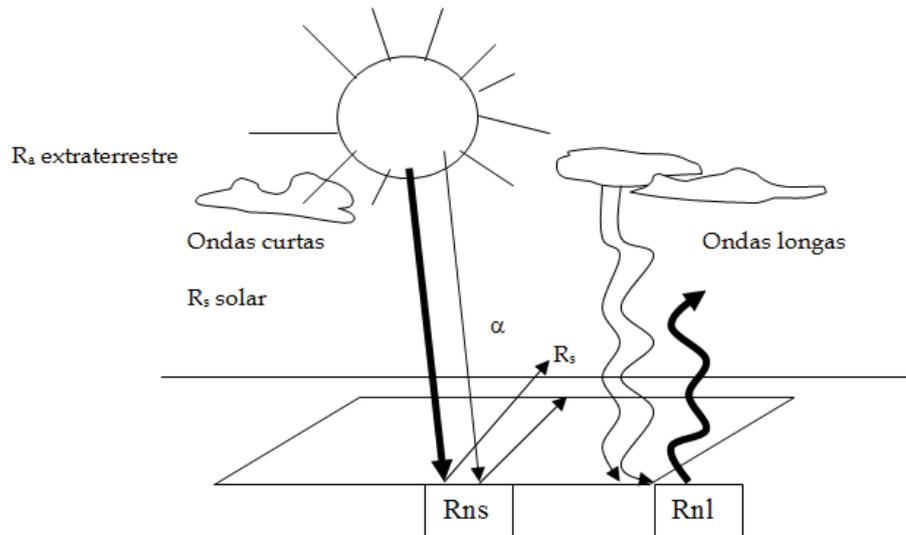
Figura 8.6 Balanço de radiação.
