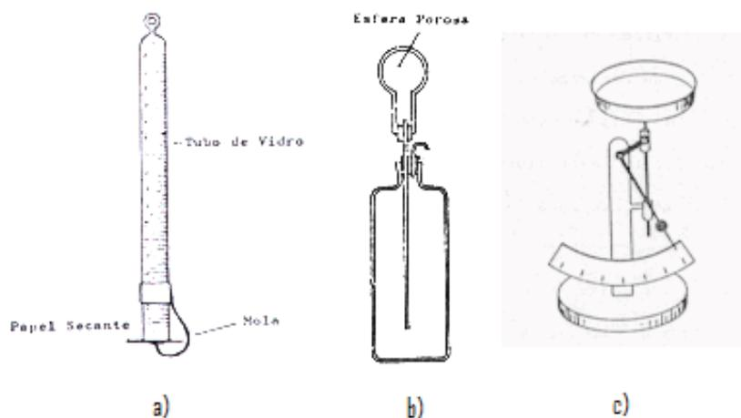
Figura 8.2 Atmômetros: a) Piche; b) Livingstone; c) Balança
