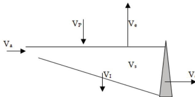
Figura 8.4 Esquematização das variáveis intervenientes no balanço de uma albufeira.
