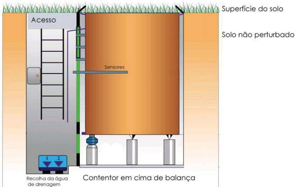
Figura 8.5 Representação esquemática de um lisímetro.
