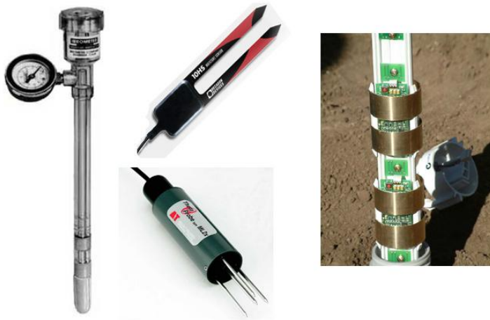
Figura 9.7 Exemplos de aparelhos utilizados na medição de teor de água no solo. Esquerda: Tensiômetro com manómetro. Centro: Sondas capacitivas Decagon e theta-probe. Direita: Sonda capacitiva Suntek (Fonte: catálogos dos fabricantes).
