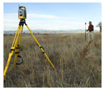
Figura 04. Demostração da utilização de uma estação total
