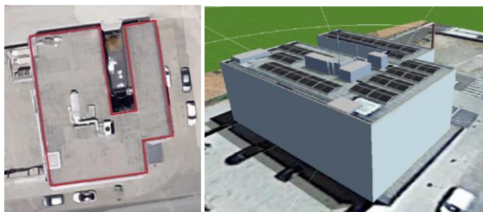
Figura 3. Cobertura do edifício do CHE-CVP e sistema fotovoltaico proposto
