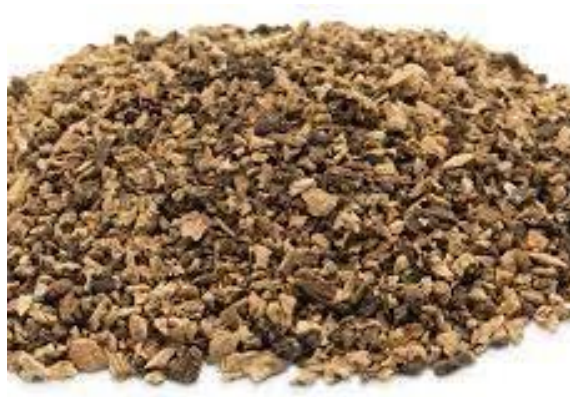
Figura 1.9 – Grânulos de cortiça expandida tratados termicamente.
