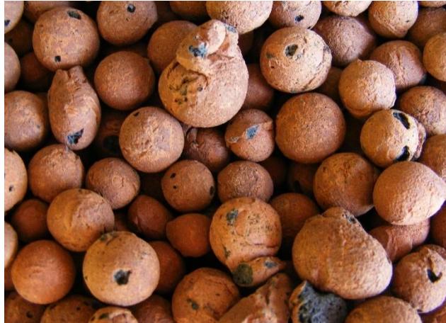
Figura 1.7 – Grânulos de agregados expandidos de argila.
