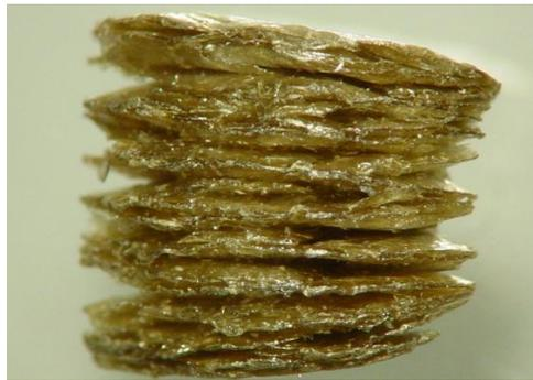
**Figura 16** - Aspeto dos flocos de Vermiculite.
