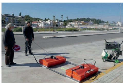
Figura 4. A la izquierda, array de barrido de frecuencias (200-300 MHz) usado para detectar el circo y el anfiteatro de Écija. A la derecha, antena biestática de 100 MHz usada para detectar vestigios del circo romano de Itálica
