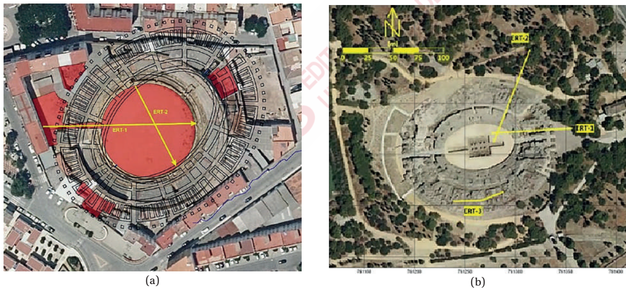
Figura 6. (a) Actuación geofísica en el entorno de la plaza de toros de Écija. Las líneas amarillas corresponden a los dos perfiles eléctricos (ERT) y las áreas rojas fueron barridas mediante georradar 3D. (b) La actuación en el anfiteatro romano de itálica ha estado condicionada por las características que ofrecía el graderío para poder implantar los perfiles eléctricos y, al mismo tiempo, elegir aquellos cortes que permitieran extrapolar el tipo de cimentación que sustenta esta estructura
