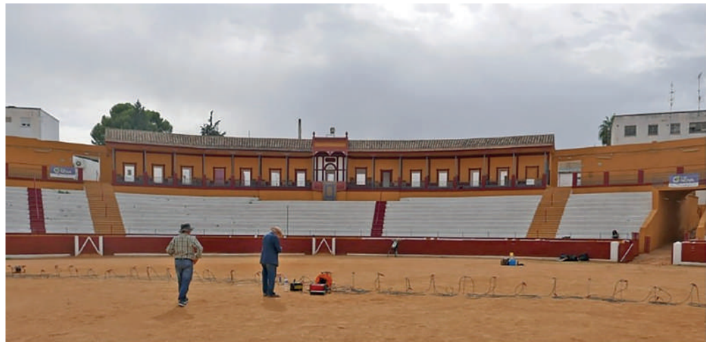
Figura 2. (a) Adquisición de uno de los dos perfiles de tomografía eléctrica realizados en la plaza de toros para localizar el anfiteatro de Écija, los electrodos (barras metálicas verticales) se espaciaron 1m entre ellos. (b) Imagen espacial de los dos perfiles que alcanzaron los 10 m de profundidad. Se detecta un tramo resistivo superior (valores rojos) compatible con restos del graderío y un cuerpo muy conductor (valores magenta) que podría relacionarse con secciones del bestiario relleno materiales muy finos y salinizados
