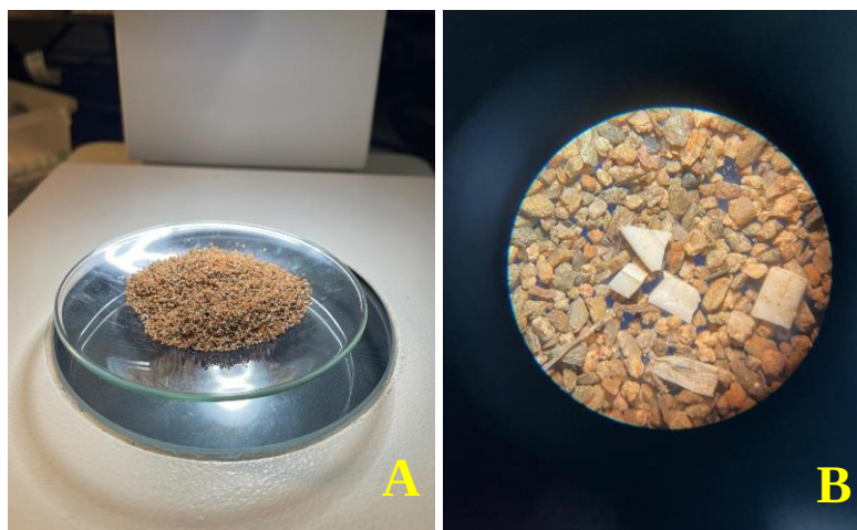
Figura 6: A- Amostra observada à lupa binocular; B - Amostra S12 observada na lupa (100x), com identificação de microplásticos.
