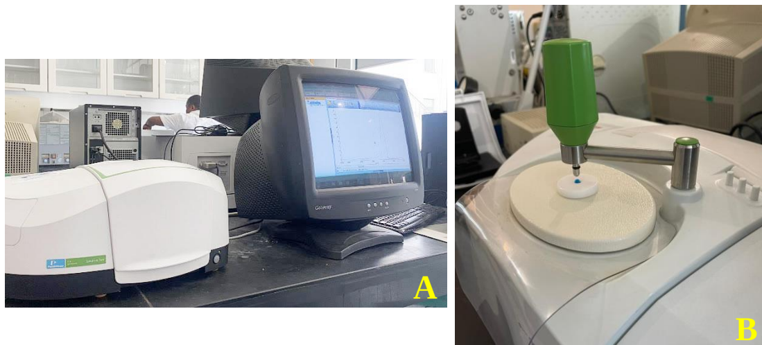
Figura 7: A. Espectrómetro FTIR-ATR (PerkinElmer Spectrum Two), acoplado com software (PerkinElmer Spectrum v. 10.5.2); B. Detalhe do acessório de Reflexão Total Atenuada (ATR).
