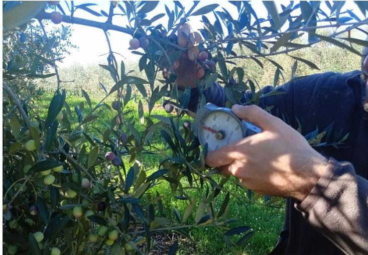
Figura 3.21 -Dinamómetro a executar a medição da força de destaque.
