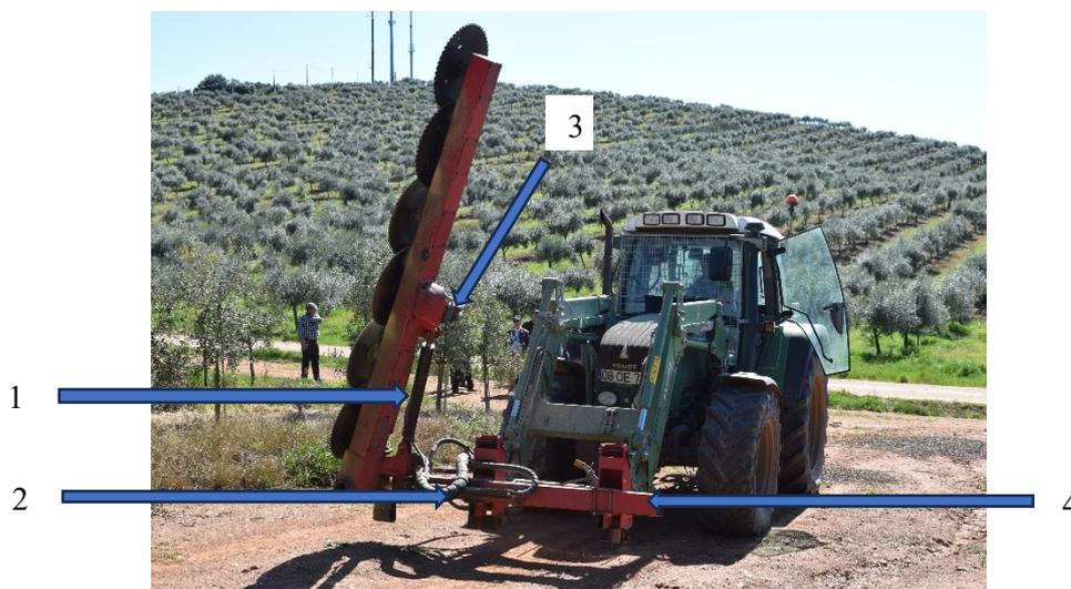
Legenda: 1- Cilindro hidráulico; 2- Cilindro hidráulico; 3- Motor hidráulico; 4-Estrutura de fixação da máquina de podar no carregador frontal do trator.
