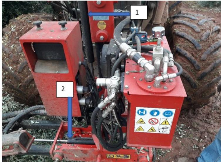
Legenda: 1-cilindro hidráulico que regula a distância da barra de corte ao solo;
