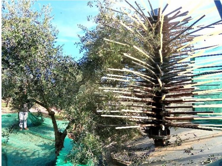
Figura 3.13 -Mastro vibratório interagindo com a copa.
