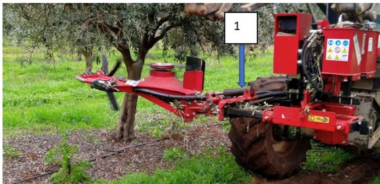
Legenda: 1- cilindro hidráulico que regula a inclinação da barra de corte.
