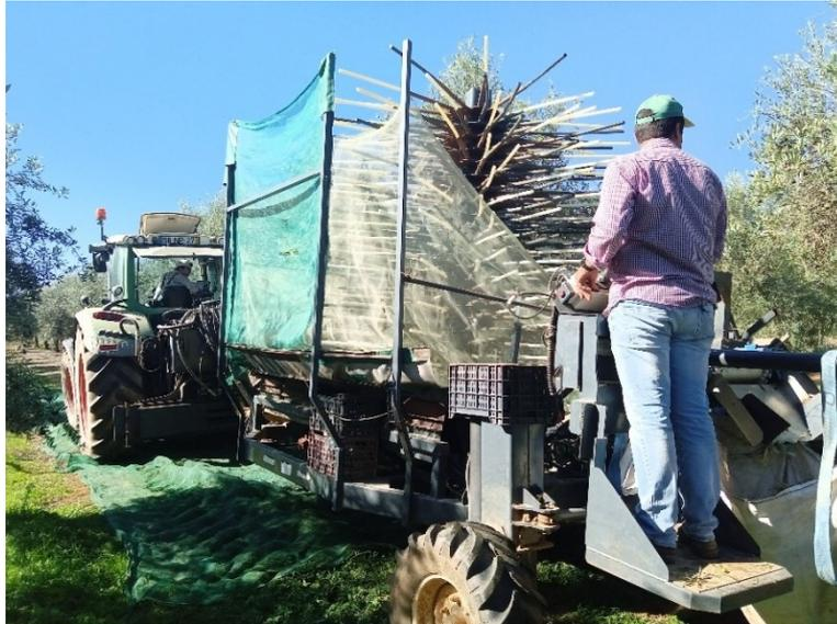
Figura 3.27 -MCCA a passar por cima de pano previamente colocado no solo.
