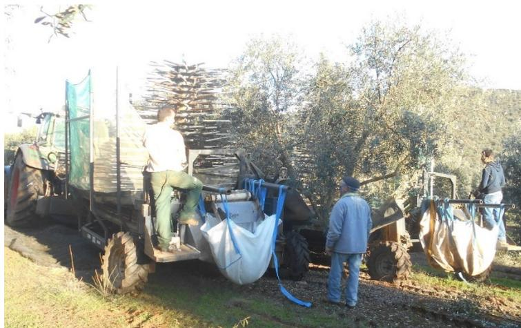
Figura 3.12 -Máquina de Colheita Contínua de Azeitona.
