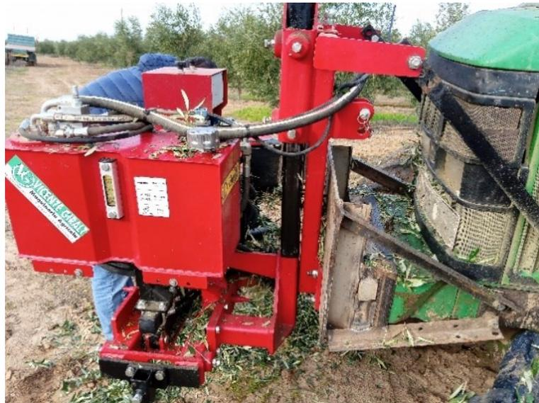
Figura 3.8 -Reservatório de óleo montado frontalmente em trator.
