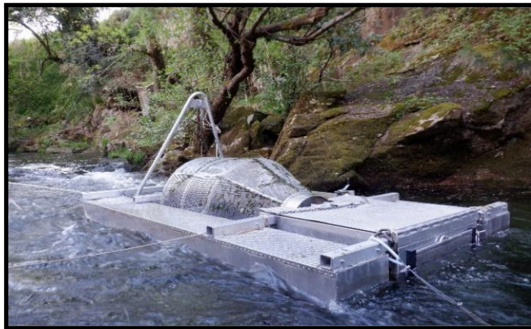
Figura 2 - Rotary Screw Trap (RST) em funcionamento no rio Mouro.
