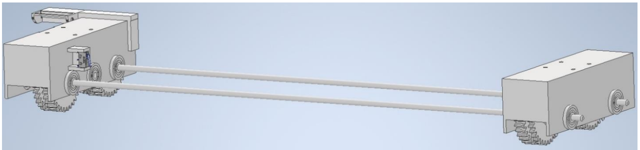
Figura 27: Estrutura completa do mecanismo movimentação eixo Y
