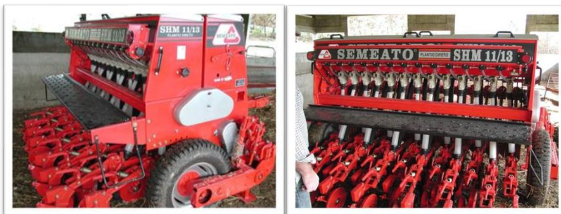
Figura 2.6.2 - Vista lateral de uma máquina de sementeira direta. **Fonte:** Freixial (2012).
