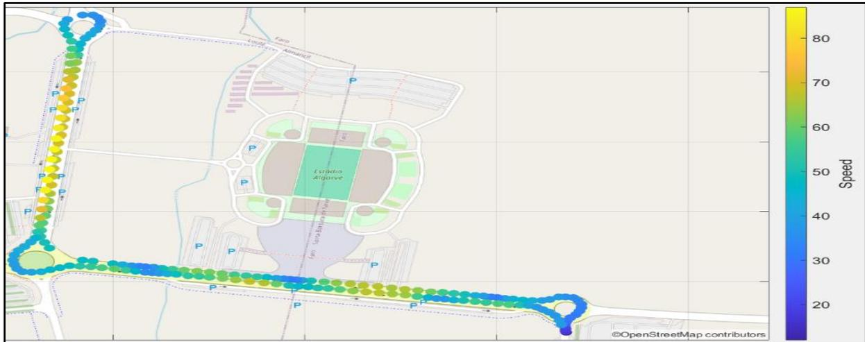
Figura 32: Posição geográfica da magnitude da velocidade em função do tempo (Volta Normal)
