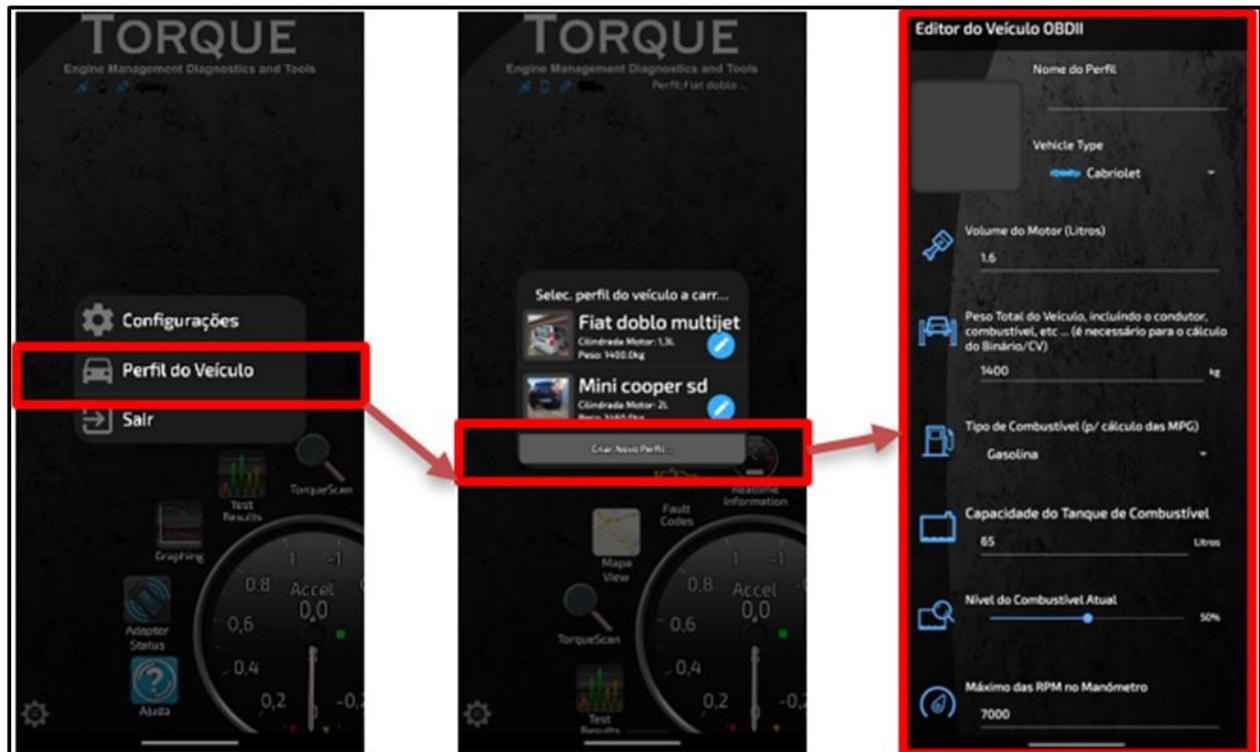
Figura 15: Aplicação Torque - Configuração do perfil do veículo
