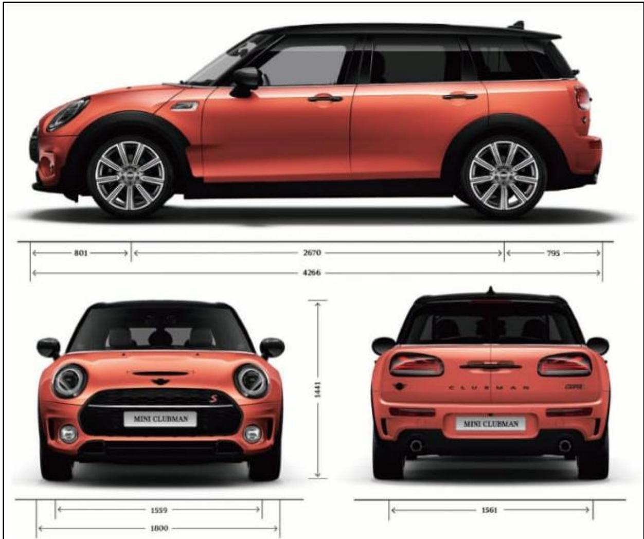
Figura 63: Dimensões do veículo em mm.; (Caetano Baviera, 2023)
