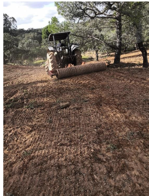
Figura 3.8 – Rolagem com rolo destorroador
