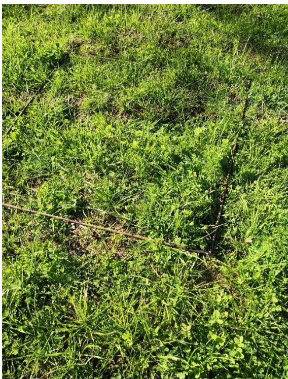
Figura 3.12 - Marcação da área para corte e recolha da amostra com o auxílio de uma estrutura em ferro.
