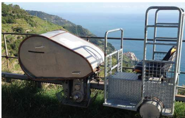
Image 43: Monorail, moteur et siège pour le conducteur. Depuis: https://www.argalombardia.eu/monterosso-riapre-la-via-dei-limoni-raggiungibile-treni-cremagliera/ consulté le 20/07/2023
