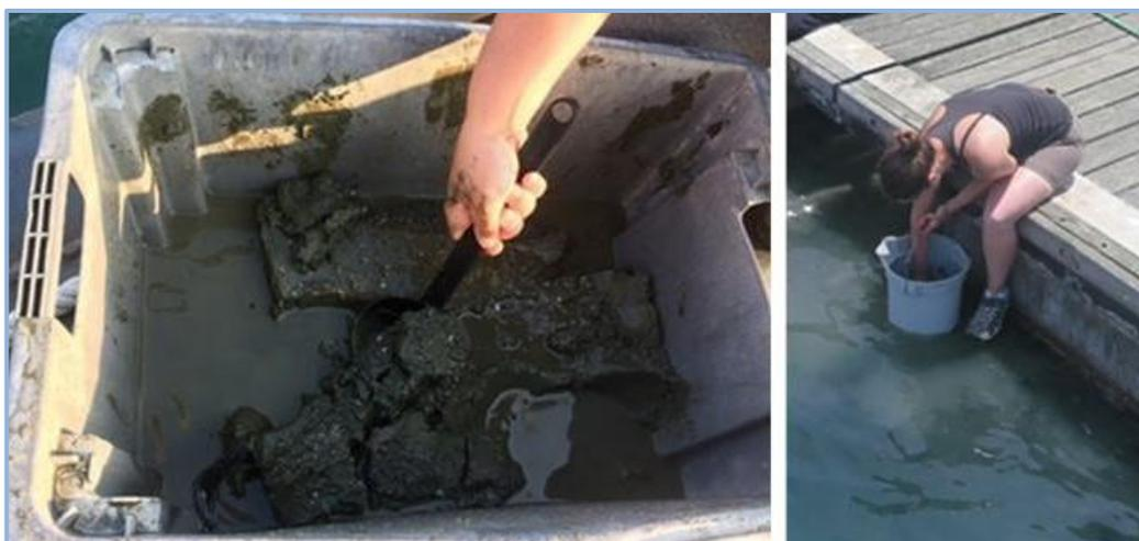
**Figura 8** - Réplica de sedimento submareal colhida para o estudo da macrofauna bentónica e lavagem de sedimento num balde com rede metálica de malha calibrada com porosidade de 0,5 mm.
