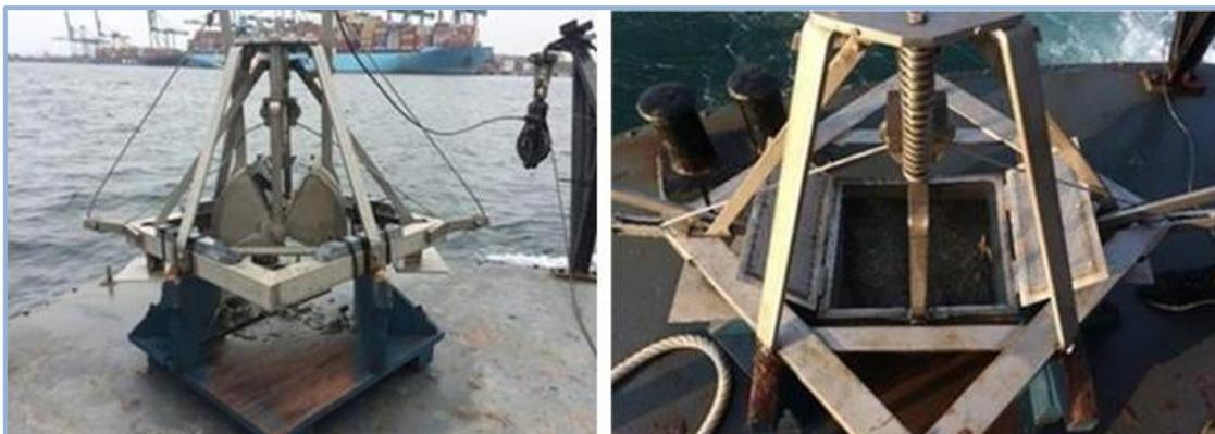
**Figura 7** - Amostragem de sedimento submareal a bordo de uma embarcação do Instituto Hidrográfico (IH), utilizando uma draga adaptada do modelo Smith-McIntyre.
