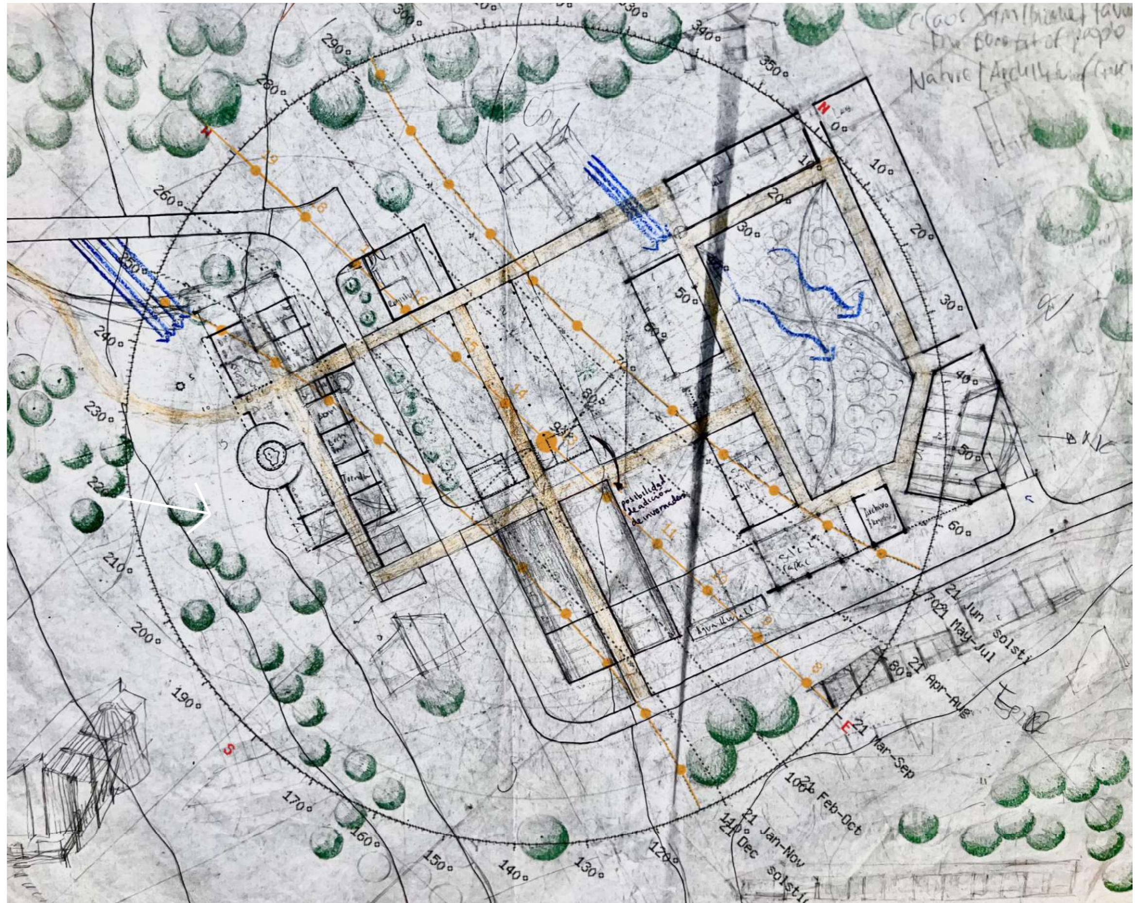
SKETCH PRIORIZANDO ORIENTACIÓN VIVEROS, INVERNADERO Y ÁREA DE FERMENTACIÓN SEGÚN RECORRIDO SOLAR Y VIENTOS
