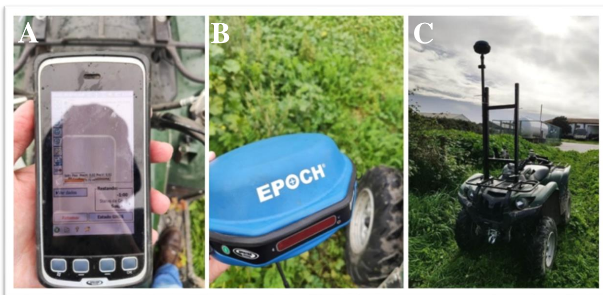
Figura 14 – Receptor GPS RTK Spectra Epoch 50 utilizado nos ensaios de campo (A – Consola de comando do GPS; B – Antena receptora do sinal GPS; C- Equipamento montado numa “moto-quatro”).
