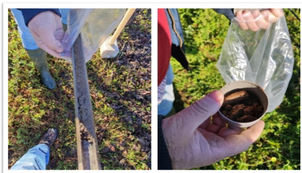
Figura 12 – Sonda “meia-cana” e maço (à esquerda); caixa de metal com amostra de solo recolhida (à direita).
