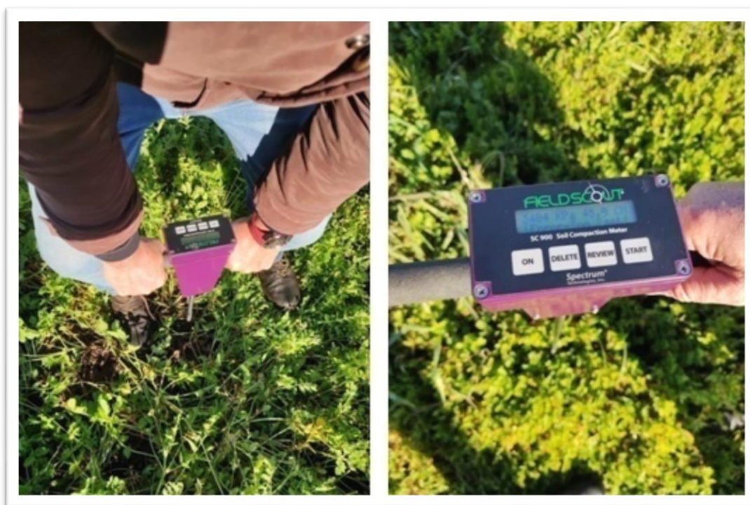
Figura 18 – Cone penetrómetro electrónico “SC-900 FieldScout” utilizado nos ensaios de campo.
